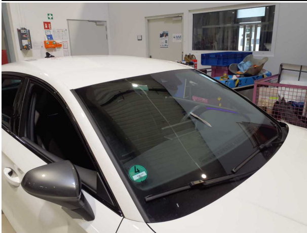
Beschädigung #2: Verglasung: Frontscheibe (mit Rissbildung) - Steinschlag - erneuern
