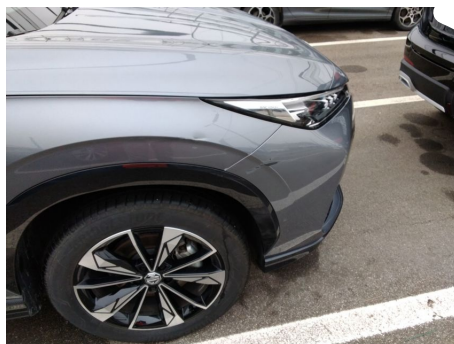
Parafango / Anteriore Destro / Rientranza
