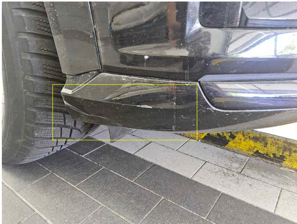
Bild 18 : Stoßfänger vorne Blende unten, zerkratzt
