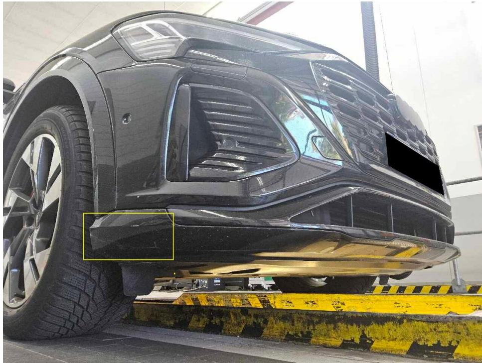
Bild 17 : Stoßfänger vorne Blende unten, zerkratzt
