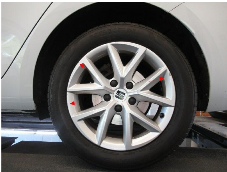
Bild 18 : Felge hinten links, zerkratzt, smart repair
