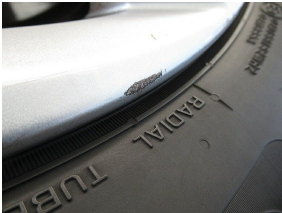
Bild 21 : Felge hinten rechts Lackierung, zerkratzt, smart repair
