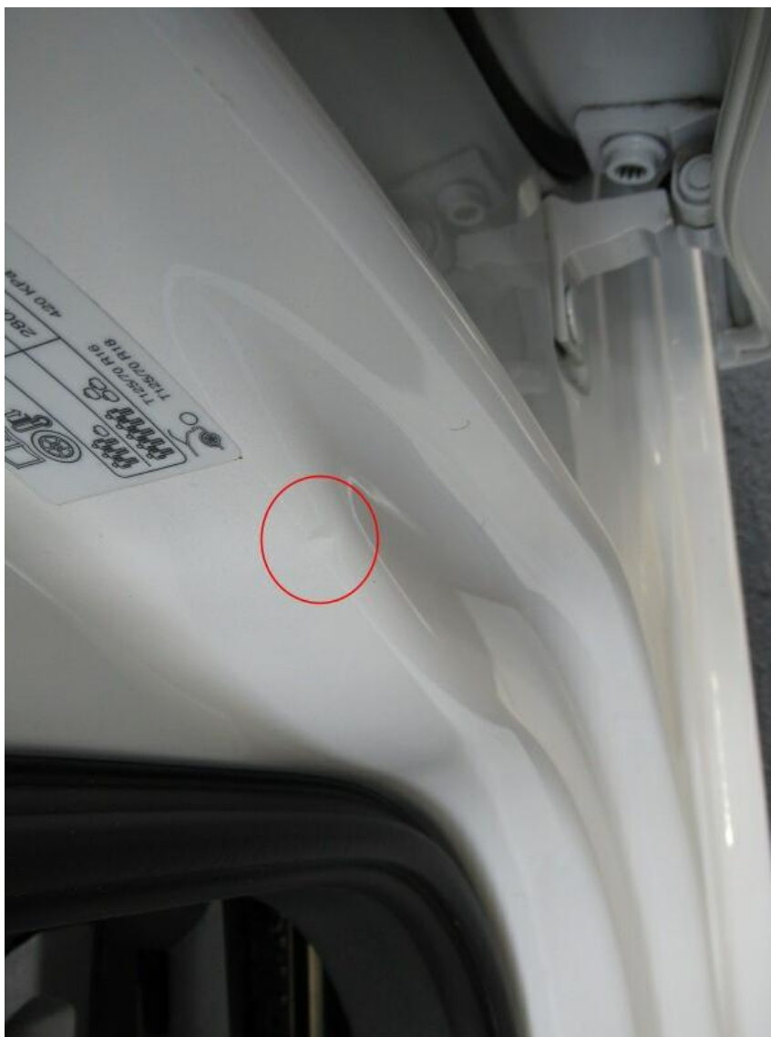
Bild 14 : Tür vorne links Einstieg, eingedellt, smart repair
