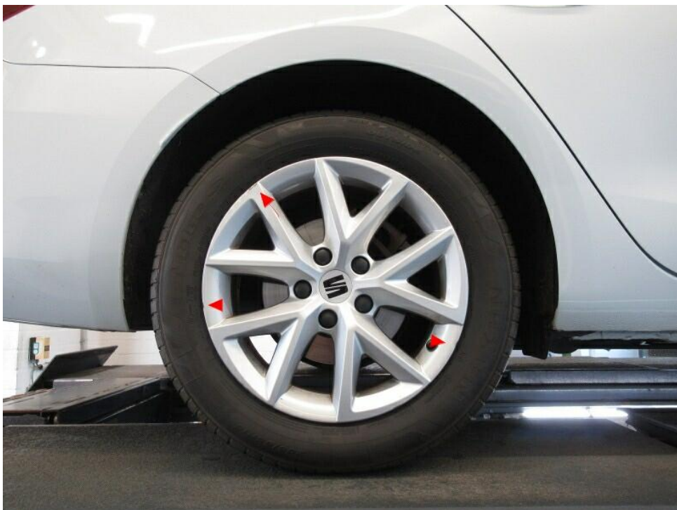
Bild 20 : Felge hinten rechts Lackierung, zerkratzt, smart repair
