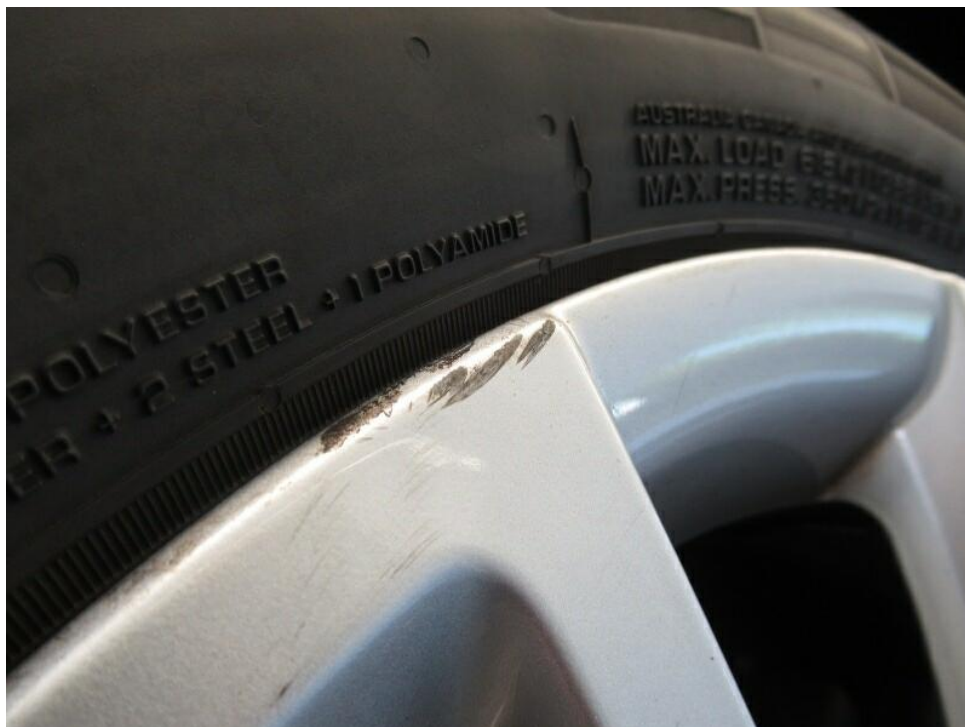
Bild 22 : Felge hinten rechts Lackierung, zerkratzt, smart repair
