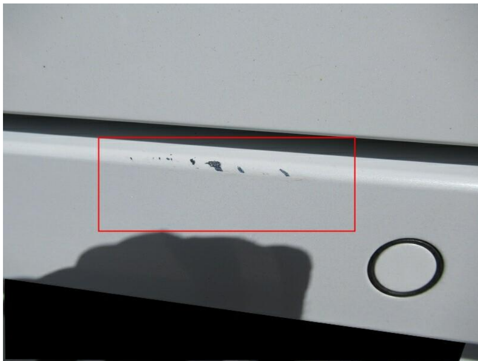
Bild 17 : Stoßfänger hinten Lackierung, zerkratzt, smart repair
