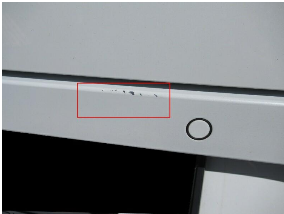
Bild 16 : Stoßfänger hinten Lackierung, zerkratzt, smart repair
