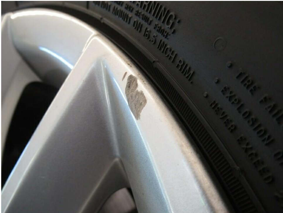
Bild 19 : Felge hinten links, zerkratzt, smart repair
