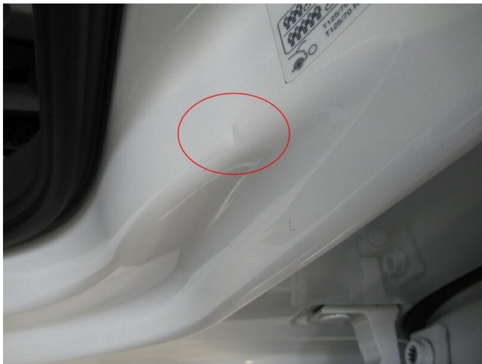
Bild 15 : Tür vorne links Einstieg, eingedellt, smart repair
