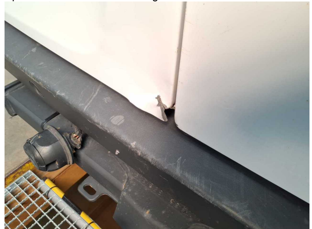
Beschädigung #13: Heckklappe/-tür: Hecktür links - gebrochen / gerissen - erneuern
