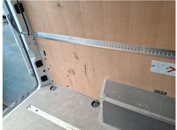
Beschädigung #9: Seitenwand links: Innenverkleidung - beschädigt - erneuern
