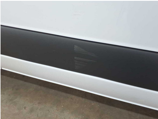
Beschädigung #2: Seitenwand links: Schutzleiste - Kratzer - Smart Repair
