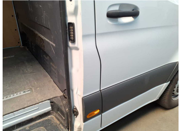
Beschädigung #10: Karosserie: B-Säule rechts - Kratzer - lackieren
