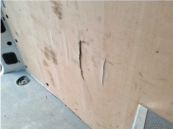
Beschädigung #9: Seitenwand links: Innenverkleidung - beschädigt - erneuern
