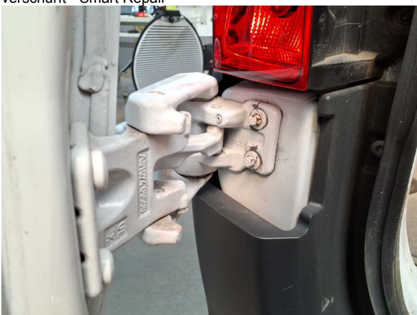
Beschädigung #7: Heckklappe/-tür: Scharnier unten (270 Grad) - verformt - erneuern
