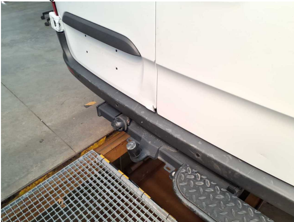
Beschädigung #13: Heckklappe/-tür: Hecktür links - gebrochen / gerissen - erneuern
