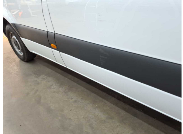
Beschädigung #2: Seitenwand links: Schutzleiste - Kratzer - Smart Repair
