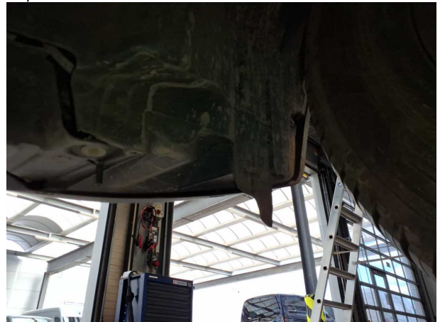
Beschädigung #3: Kotflügel rechts: Innenkotflügel vorn - gebrochen / gerissen - erneuern
