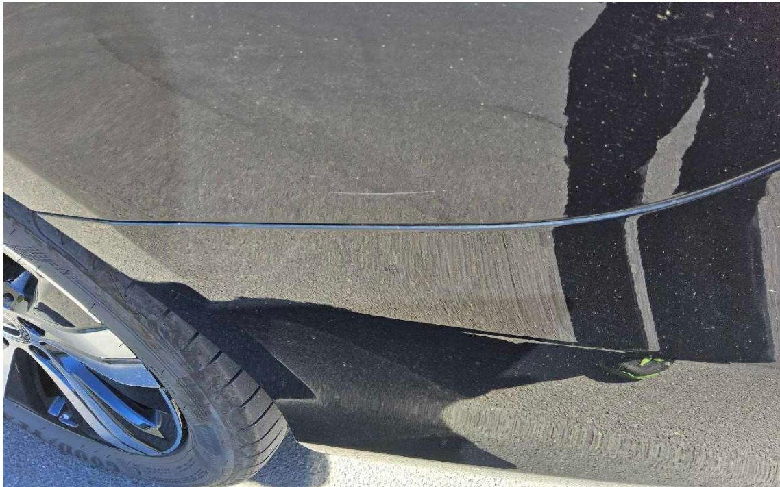
Bild 18 : Seitenwand links leicht zerkratzt
