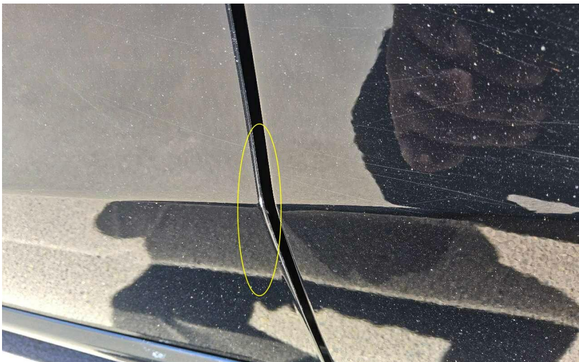
Bild 19 : Türkante vorne links leicht verschrammt
