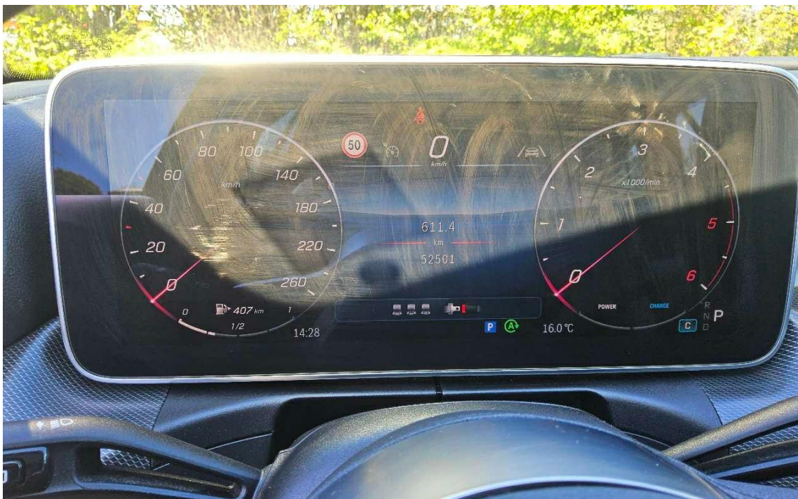
Bild 6 : Kombiinstrument (betriebsbereit) mit Km-Stand
