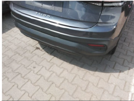
Stoßfänger unterhalb / Hinten / Kratzer
