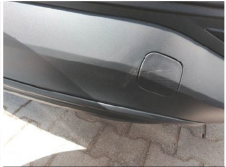
Stoßfänger unterhalb / Hinten / Kratzer
