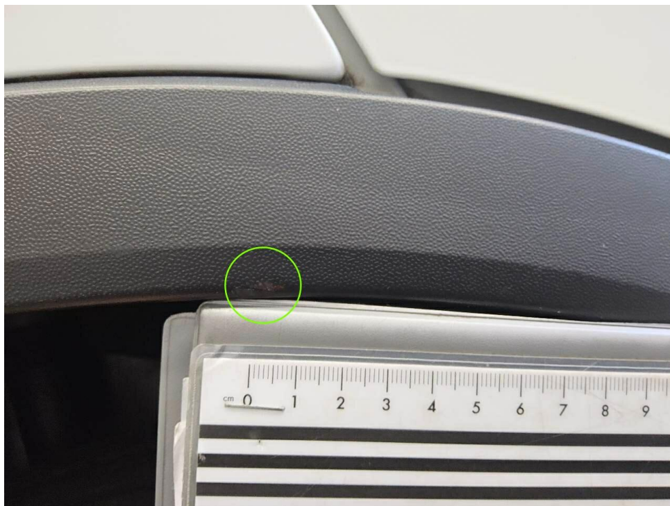
Bild 15 : Seitenteil hinten rechts Zierleiste, verschrammt
