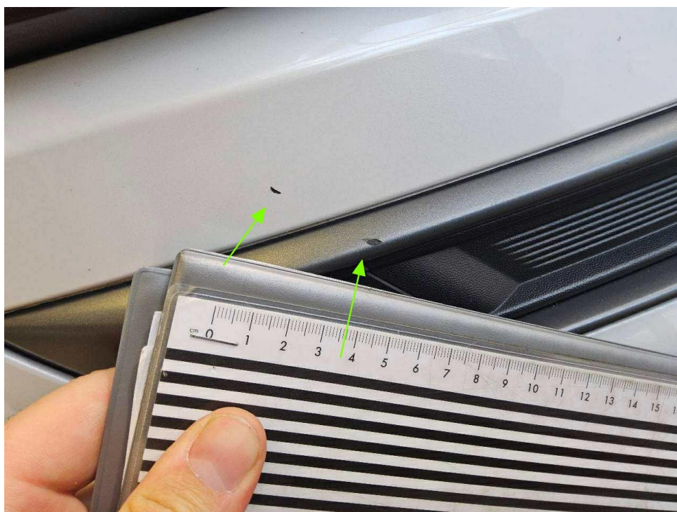
Bild 16 : Stoßfänger vorne Lackierung, zerkratzt
