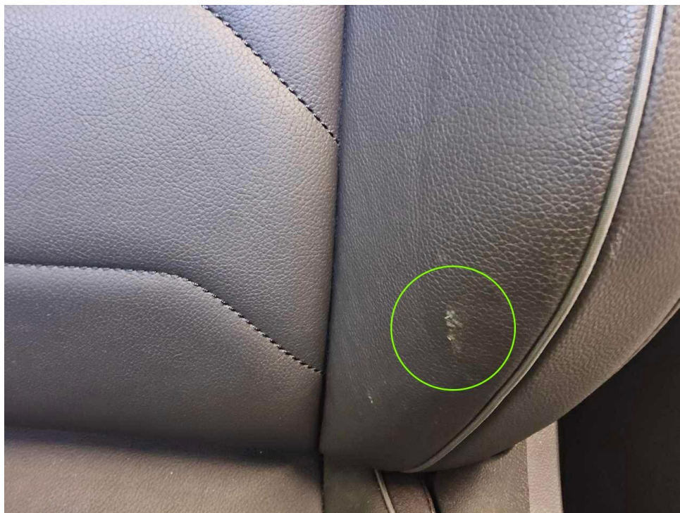
Bild 13 : Sitz vorne links Sitzlehnenbezug, verschlissen
