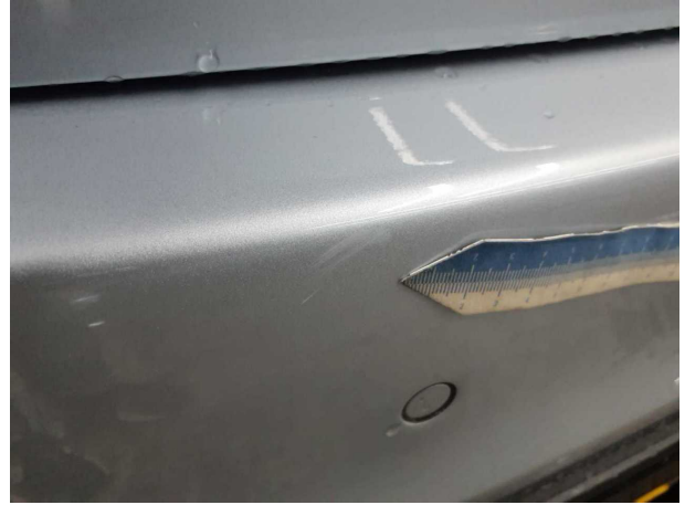
Beschädigung #1: Stossfänger hinten: Stossfänger mit Parktronic - Kratzer - Smart Repair
