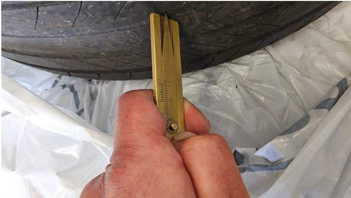
Bild 49 : Sommerreifen Vorderachse, verschlissen
