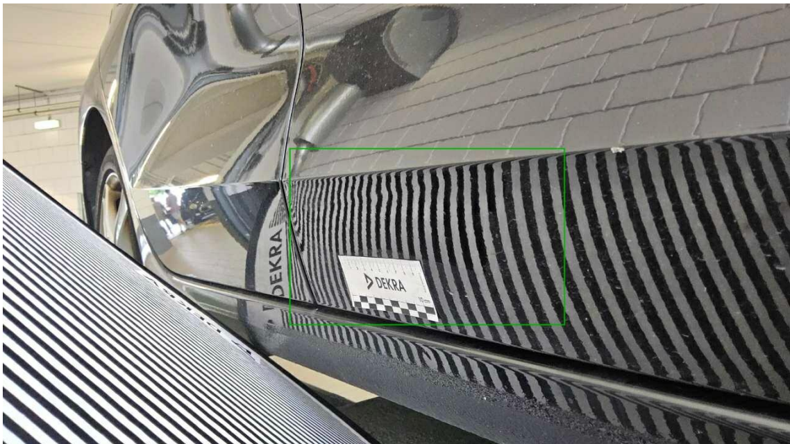
Bild 22 : Tür vorne rechts Lackierung unterhalb, fleckig, lackieren mit Lackaufbau
