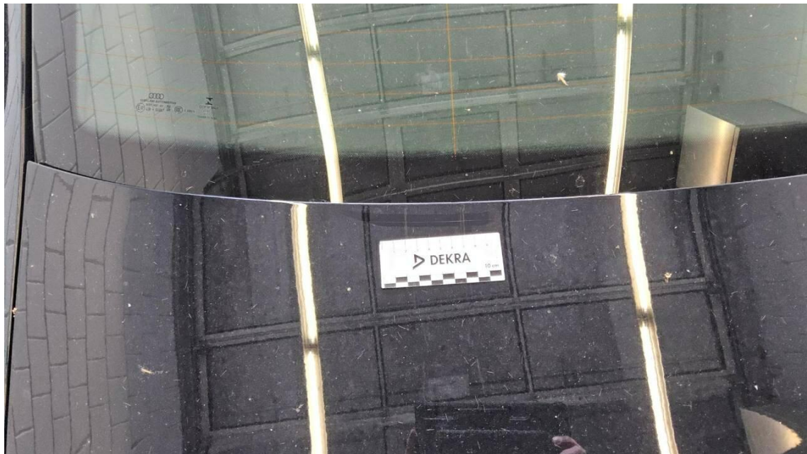
Bild 39 : Heckdeckel Lackierung, zerkratzt, lackieren mit Lackaufbau
