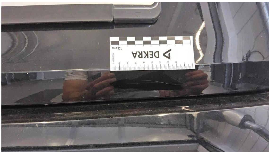
Bild 38 : Heckdeckel Lackierung, zerkratzt, lackieren mit Lackaufbau
