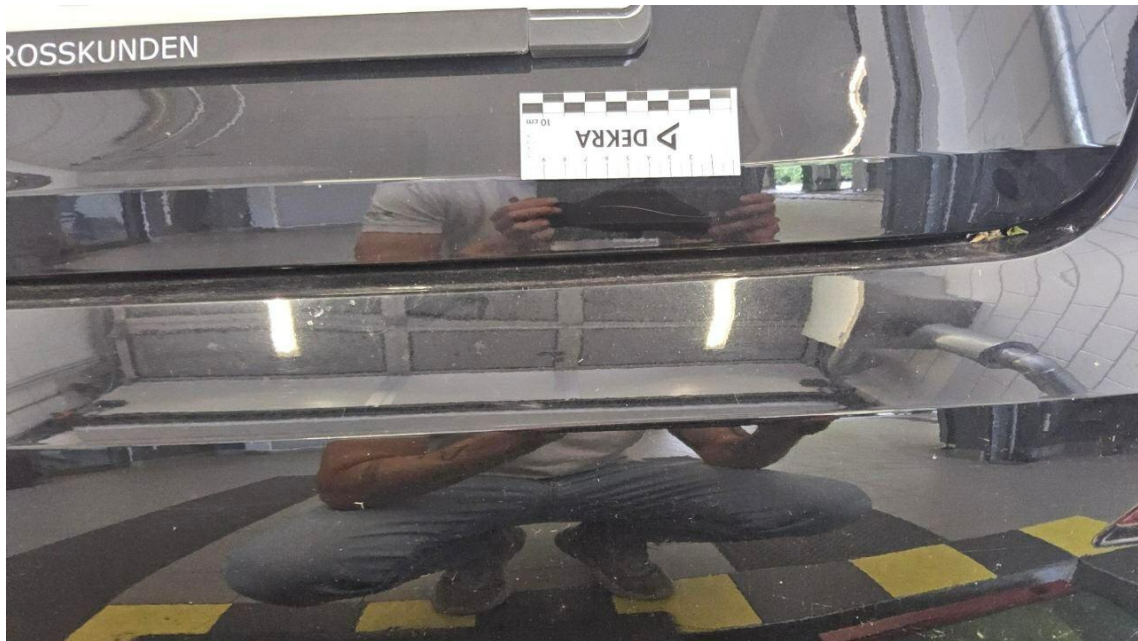
Bild 37 : Heckdeckel Lackierung, zerkratzt, lackieren mit Lackaufbau
