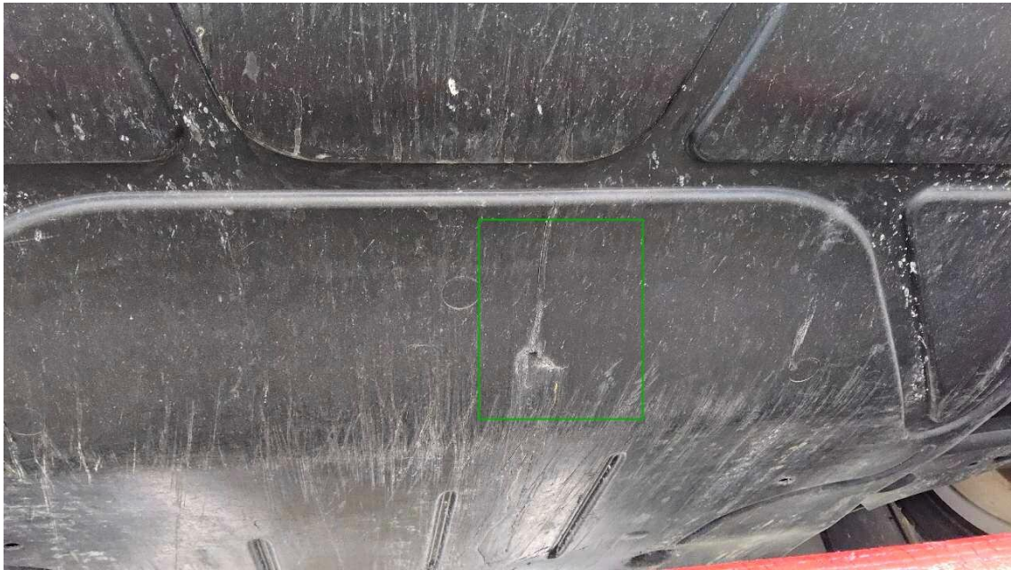
Bild 53 : Unterbodenverkleidung Motor, gebrochen
