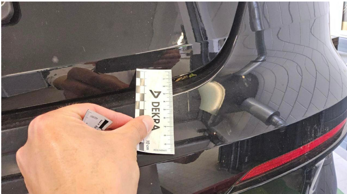
Bild 28 : Stoßfänger hinten Lackierung, zerkratzt, lackieren mit Lackaufbau
