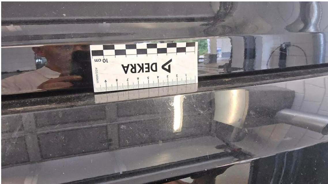
Bild 26 : Stoßfänger hinten Lackierung, zerkratzt, lackieren mit Lackaufbau
