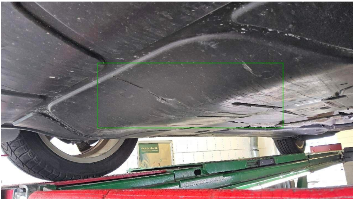
Bild 54 : Unterbodenverkleidung Motor, gebrochen
