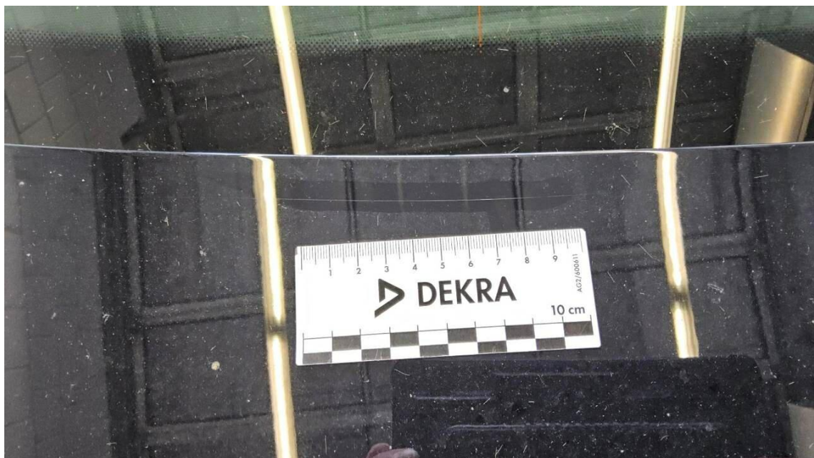
Bild 40 : Heckdeckel Lackierung, zerkratzt, lackieren mit Lackaufbau
