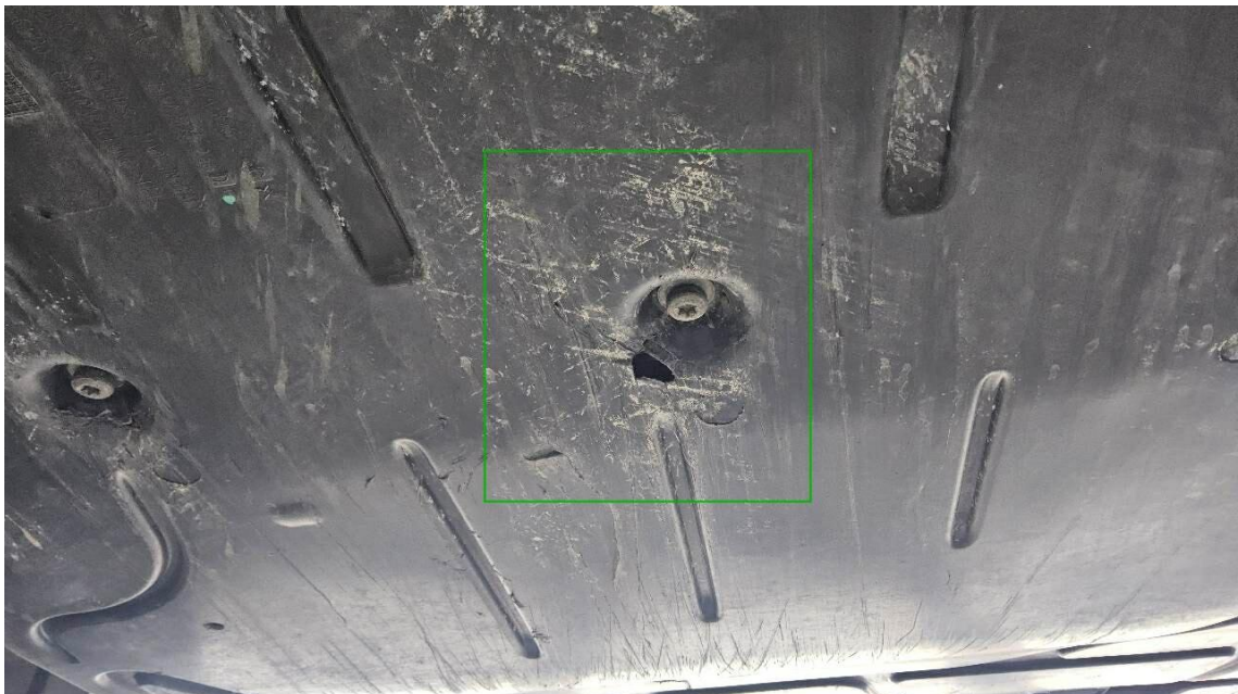
Bild 52 : Unterbodenverkleidung Motor, gebrochen
