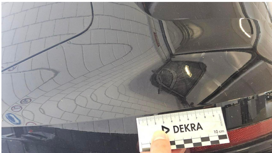
Bild 24 : Stoßfänger hinten Lackierung, zerkratzt, lackieren mit Lackaufbau
