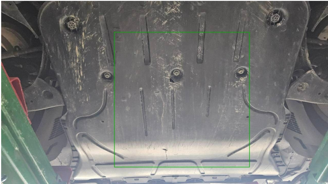
Bild 51 : Unterbodenverkleidung Motor, gebrochen
