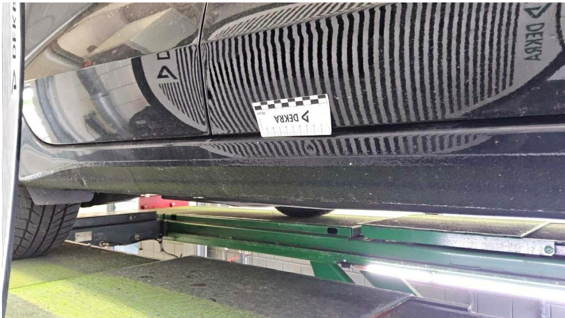
Bild 41 : Seitenschweller rechts, eingedellt, Gebrauchsspur
