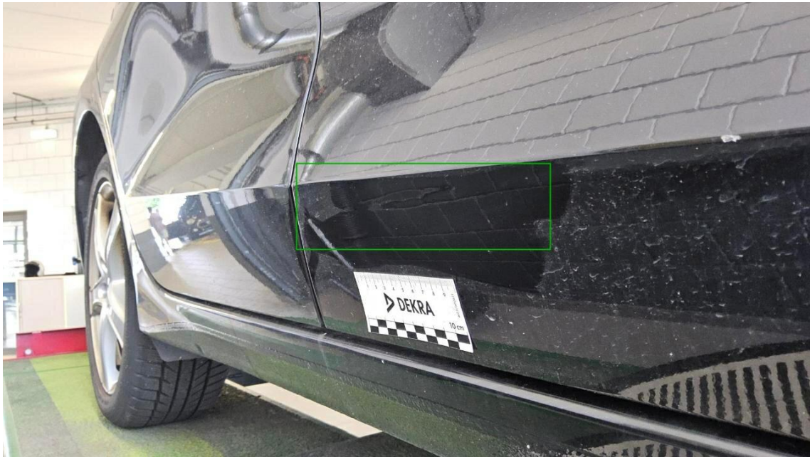
Bild 21 : Tür vorne rechts Lackierung unterhalb, fleckig, lackieren mit Lackaufbau
