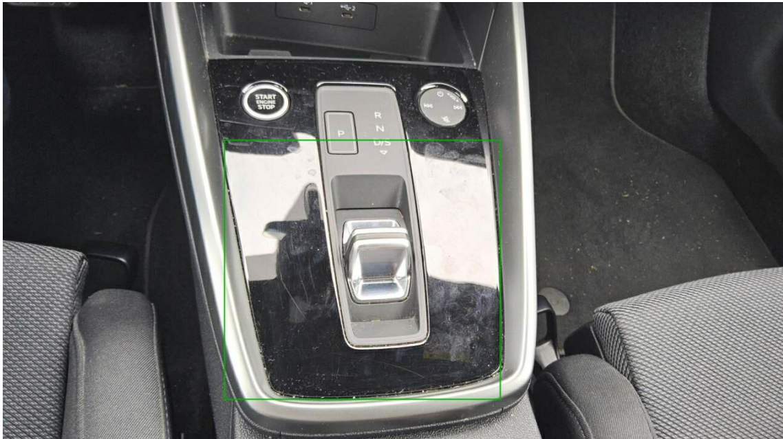
Bild 45 : Mittelkonsole unten, zerkratzt, Gebrauchsspur
