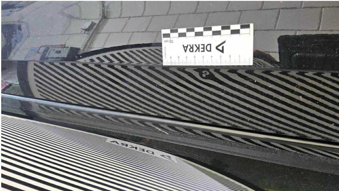
Bild 31 : Tür vorne links, mehrfach eingedellt, drücken
