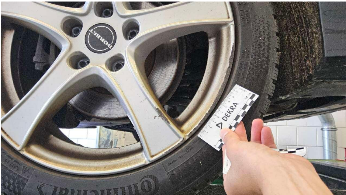
Bild 50 : Felge hinten links Winteradsatz, verkratzt mit Materialabtrag
