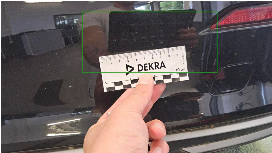
Bild 27 : Stoßfänger hinten Lackierung, zerkratzt, lackieren mit Lackaufbau
