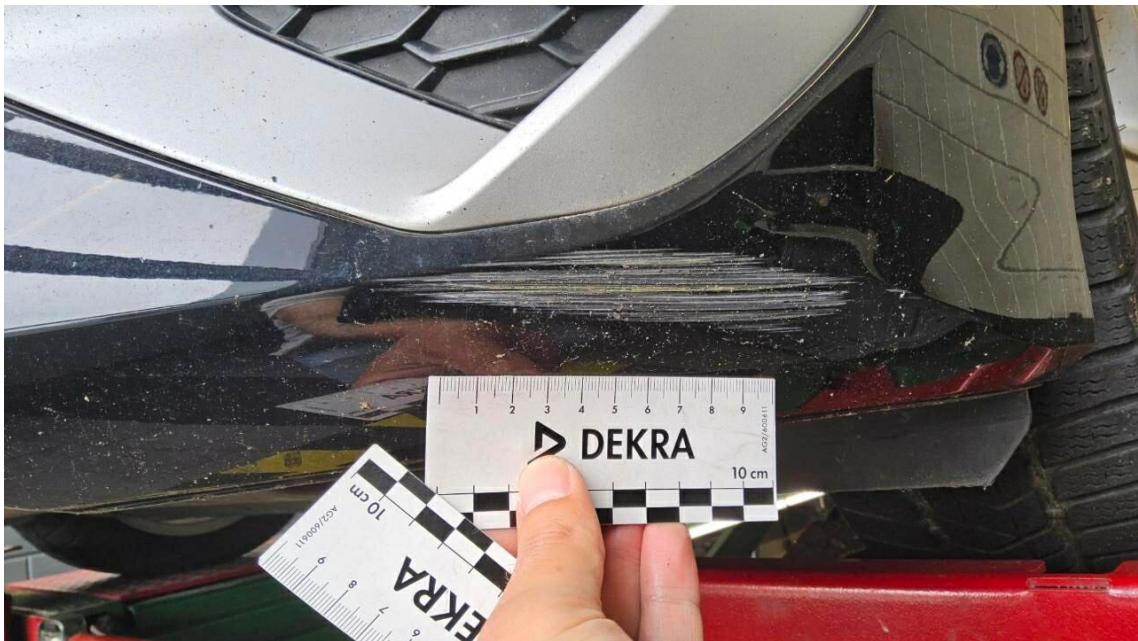
Bild 18 : Stoßfänger vorne Lackierung, zerkratzt, lackieren mit Lackaufbau
