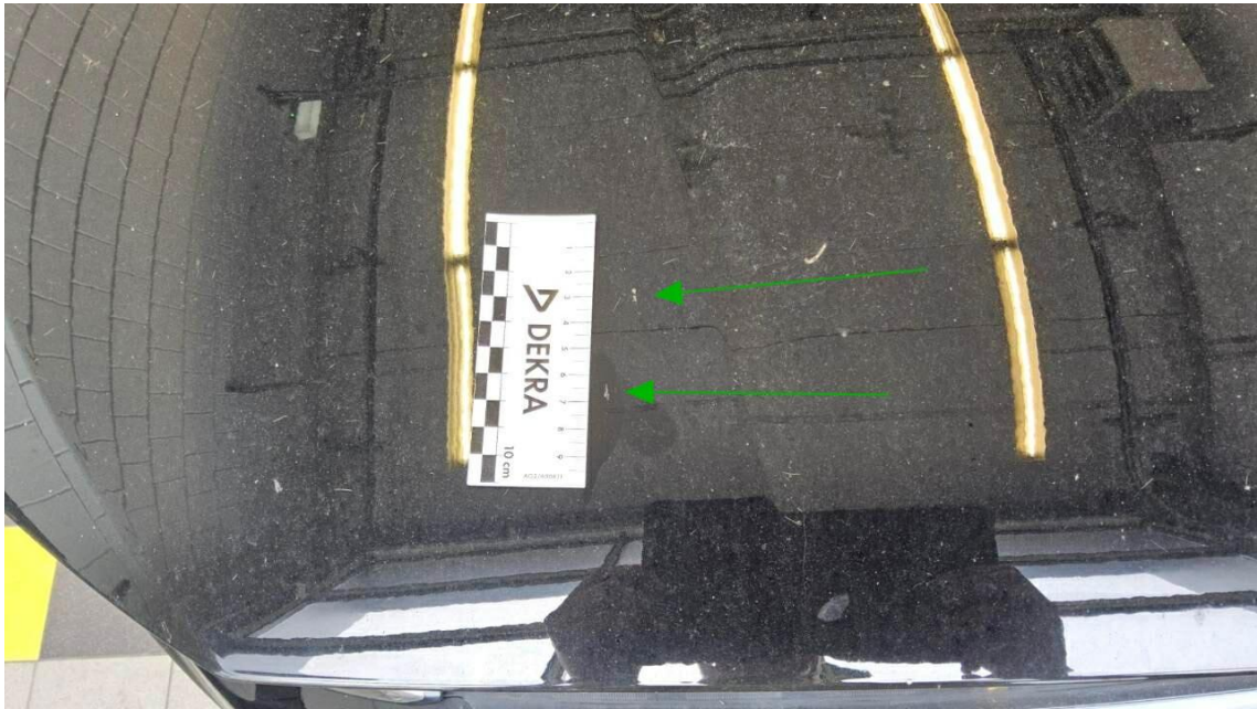
Bild 33 : Motorhaube Lackierung, Steinschlag, lackieren mit Lackaufbau
