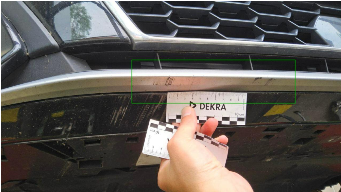
Bild 15 : Frontspoiler Lackierung, zerkratzt, lackieren mit Lackaufbau
