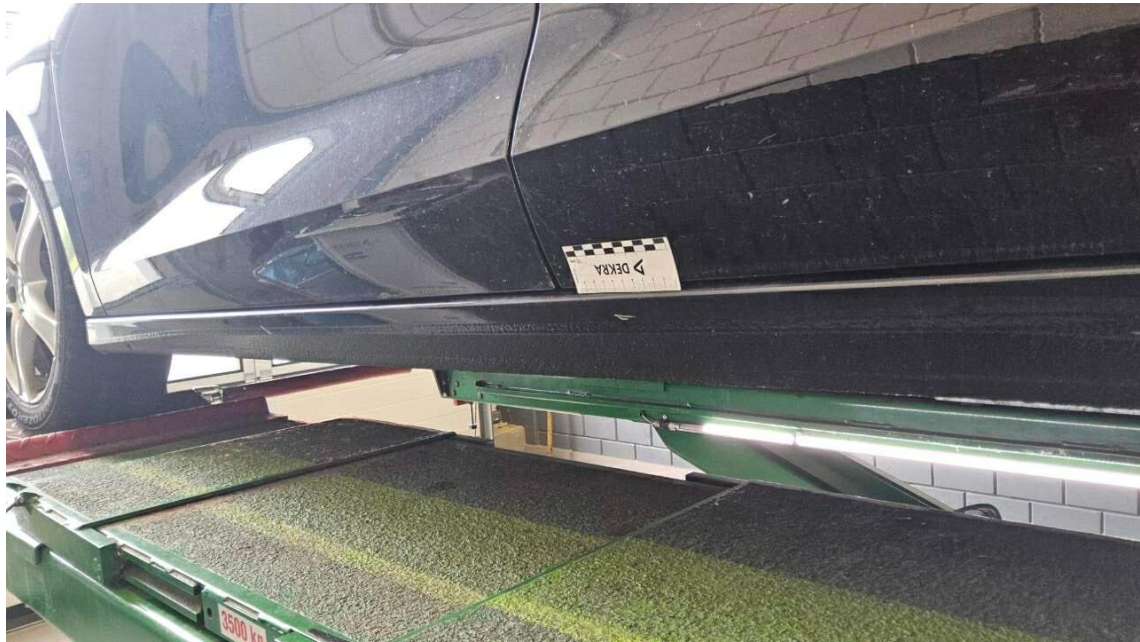
Bild 29 : Seitenschweller links Lackierung, zerkratzt, lackieren mit Lackaufbau
