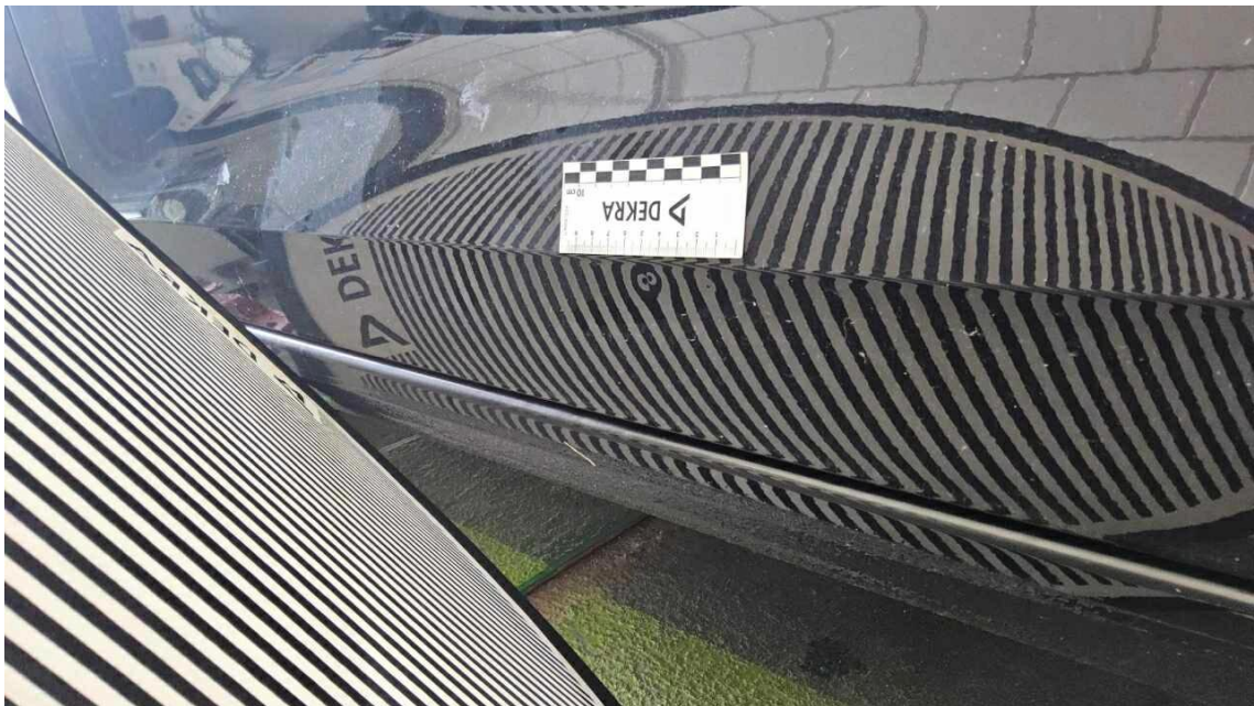
Bild 32 : Tür vorne links, mehrfach eingedellt, drücken
