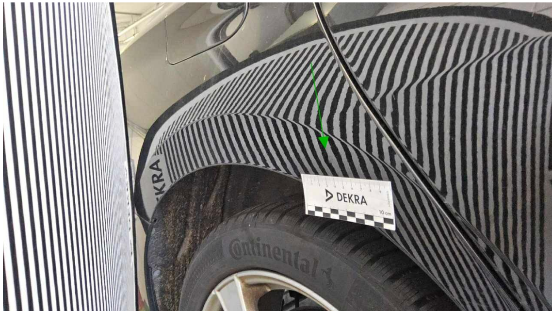
Bild 23 : Seitenteil hinten rechts, eingedellt, Gebrauchsspur
