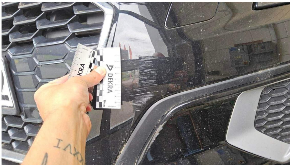
Bild 19 : Stoßfänger vorne Lackierung, zerkratzt, lackieren mit Lackaufbau
