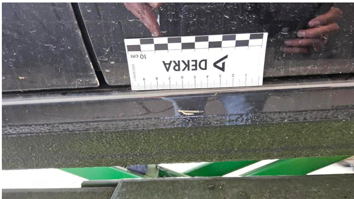
Bild 30 : Seitenschweller links Lackierung, zerkratzt, lackieren mit Lackaufbau
