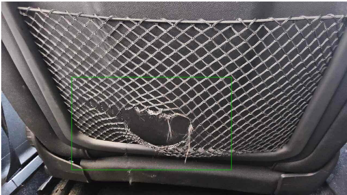
Bild 47 : Netz Rückenlehnenabdeckung Fahrersitz, gerissen
