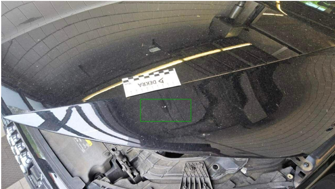
Bild 35 : Motorhaube Lackierung, Steinschlag, lackieren mit Lackaufbau
