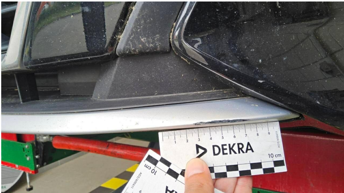
Bild 14 : Frontspoiler Lackierung, zerkratzt, lackieren mit Lackaufbau
