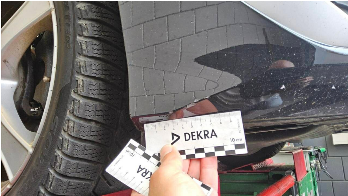
Bild 17 : Stoßfänger vorne Lackierung, zerkratzt, lackieren mit Lackaufbau
