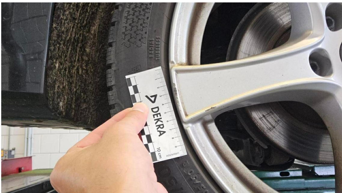
Bild 42 : Felge hinten rechts, zerkratzt, lackieren mit Lackaufbau
