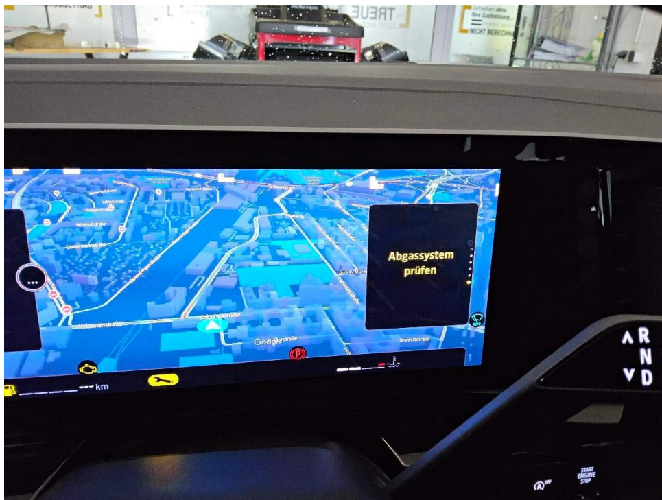
Bild 11 : Fehlermeldung "Abgassystem prüfen"
