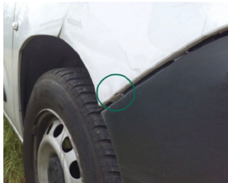
Haut de pare-chocs / Avant / Enfoncement
