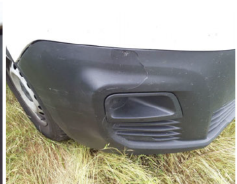
Bas de pare-chocs / Avant / Cassé
