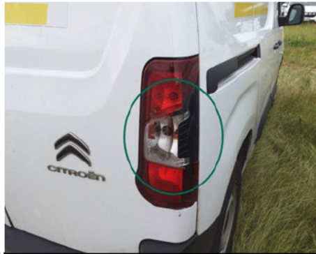
Bloc feu (d'alle) / Arrière Droit / Cassé
