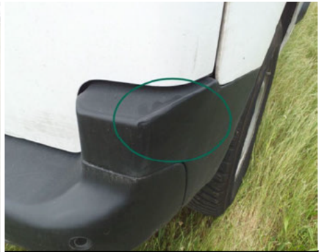
Pare-chocs / Arrière Droit / Enfoncement
