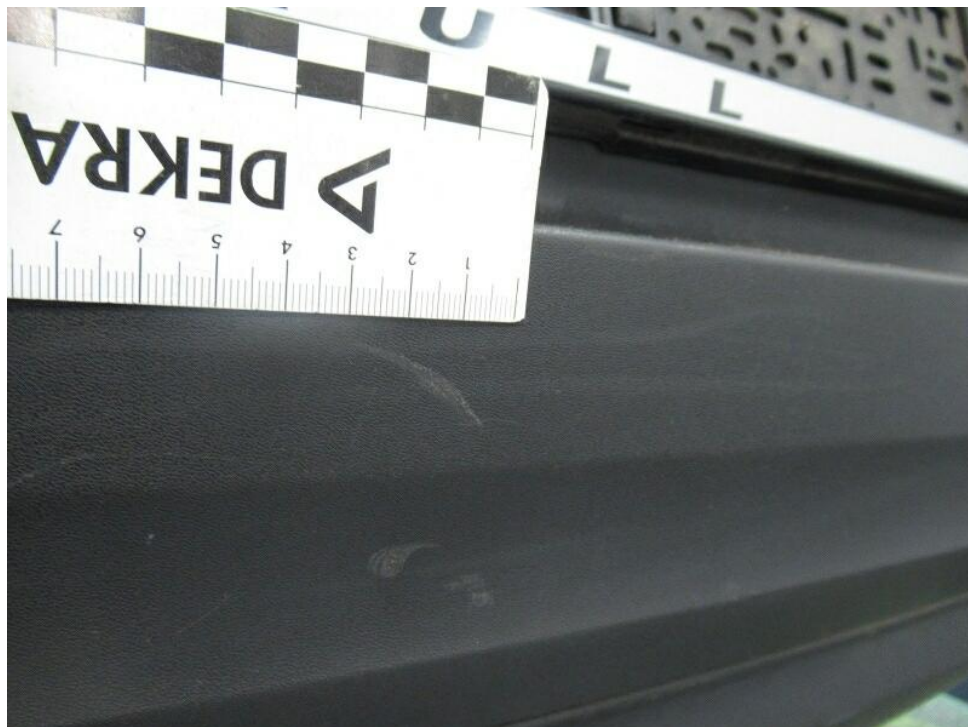
Bild 20 : Stoßfänger hinten zerkratzt
