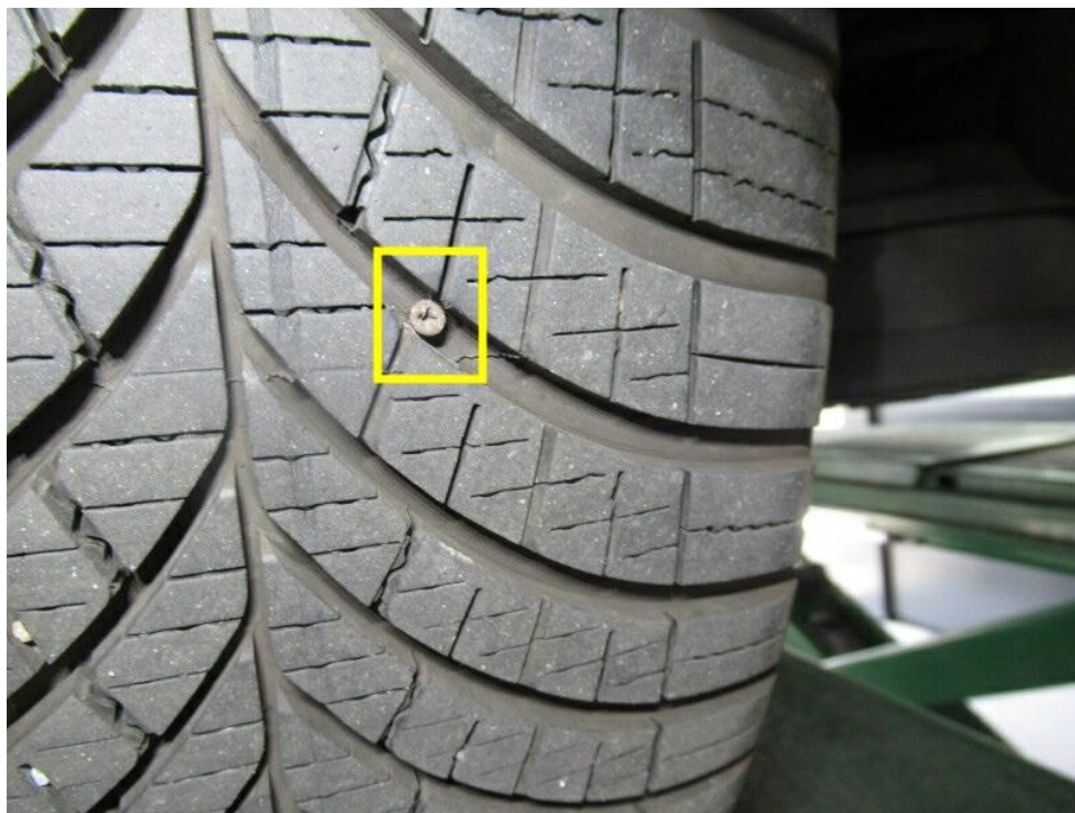
Bild 22 : Reifen hinten links Schraube in Lauffläche
