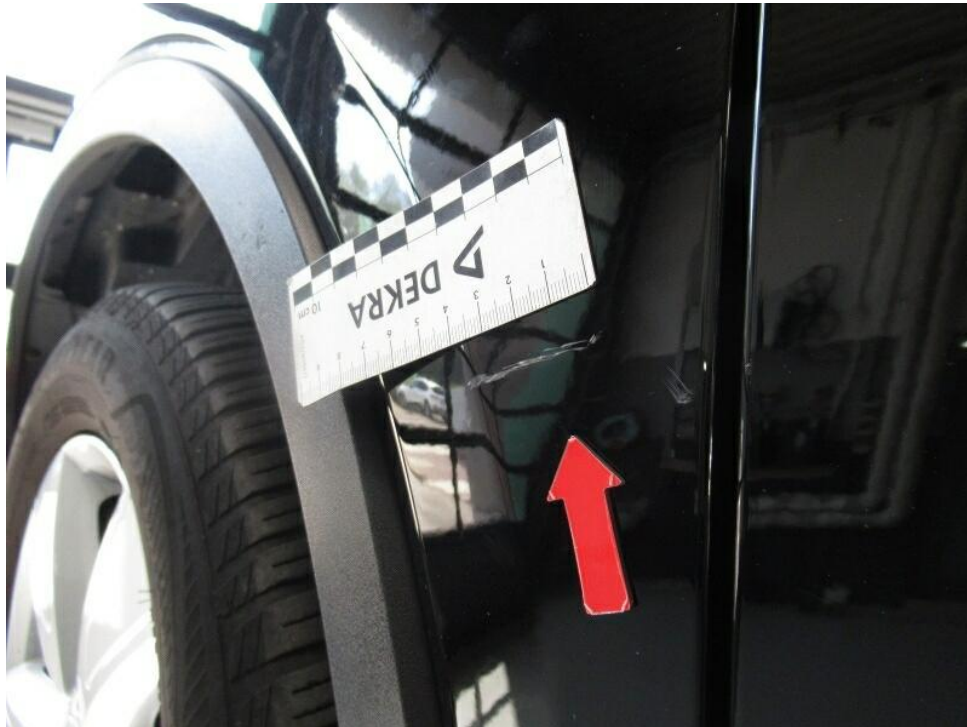
Bild 23 : Kotflügel links zerkratzt und eingedellt
