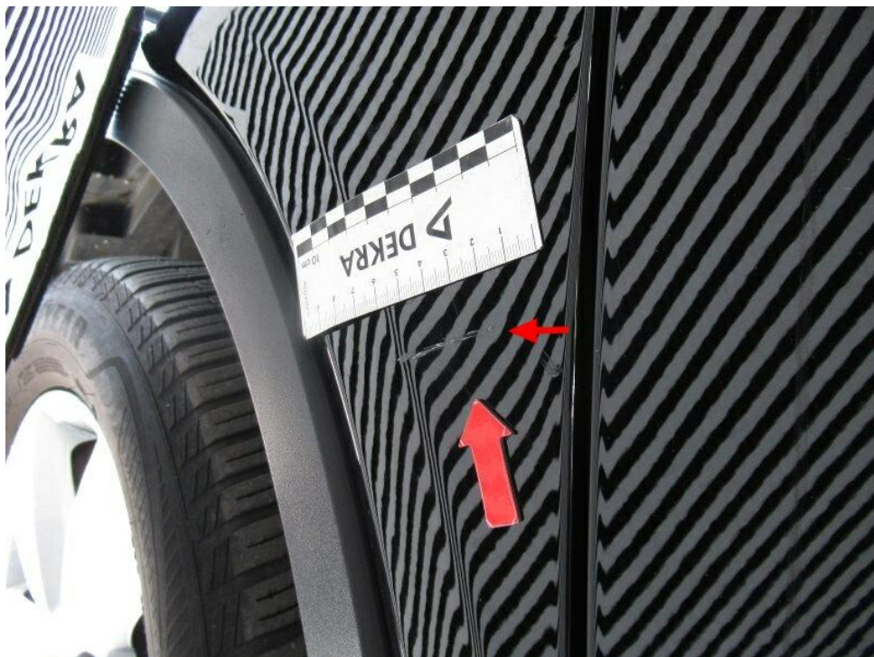
Bild 24 : Kotflügel links zerkratzt und eingedellt
