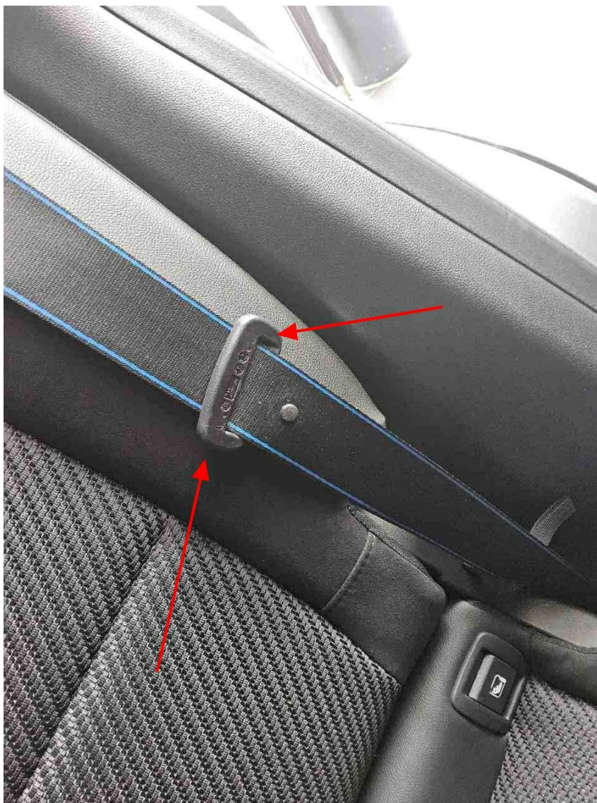
Bild 10 : Sicherheitsgurt hinten links verdreht, instandsetzen
