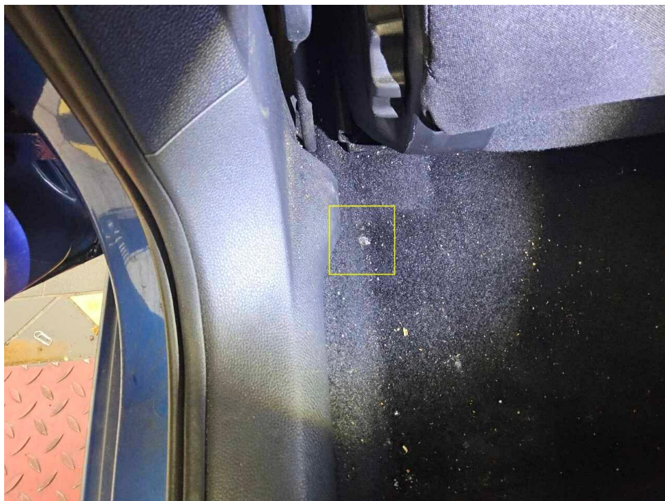
Bild 26 : Bodenbelag vorne links, verschlissen
