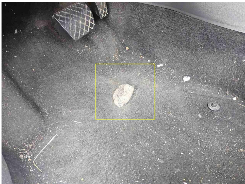
Bild 24 : Bodenbelag vorne links, verschlissen
