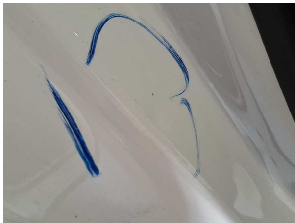
Beschädigung #3: Seitenwand rechts: Einstieg - Delle(n) - sanft instandsetzen
