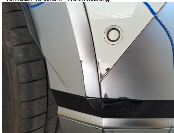
Beschädigung #8: Seitenwand links: Radhausverbreiterung - verkratzt / verschürft - erneuern
