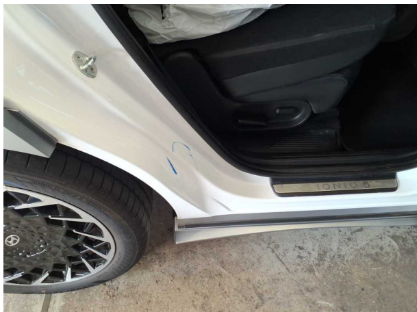
Beschädigung #3: Seitenwand rechts: Einstieg - Delle(n) - sanft instandsetzen
