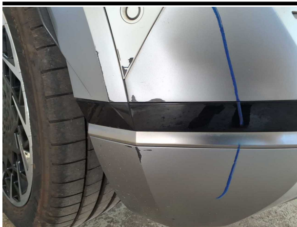
Beschädigung #9: Stossfänger hinten: Spoiler - verkratzt / verschürft - erneuern
