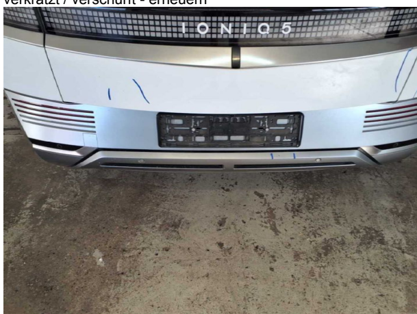
Beschädigung #9: Stossfänger hinten: Spoiler - verkratzt / verschürft - erneuern
