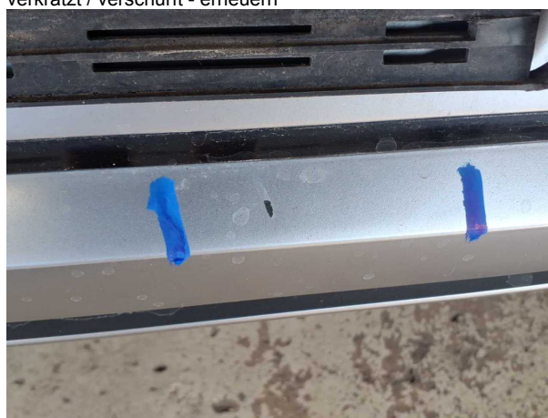
Beschädigung #9: Stossfänger hinten: Spoiler - verkratzt / verschürft - erneuern
