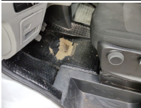
Teppichboden / Vorne Links / Riss
