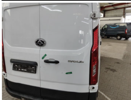
Tür / Hinten Rechts / Delle
