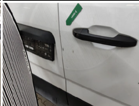
Tür / Hinten Rechts / Delle
