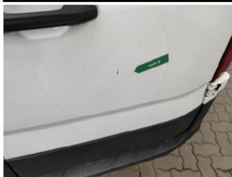
Tür / Hinten Rechts / Delle
