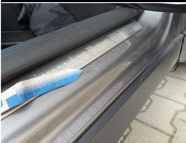
Beschädigung #3: Schweller rechts: Einstieg - verformt - Smart Repair
