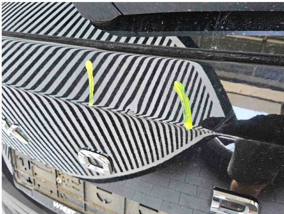
Bild 22 : Heckklappe, eingedellt, instandsetzen und lackieren mit Lackaufbau
