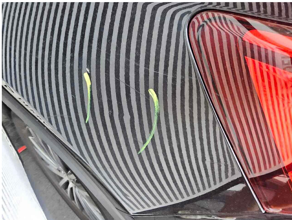
Bild 20 : Seitenteil hinten links, eingedellt, drücken
