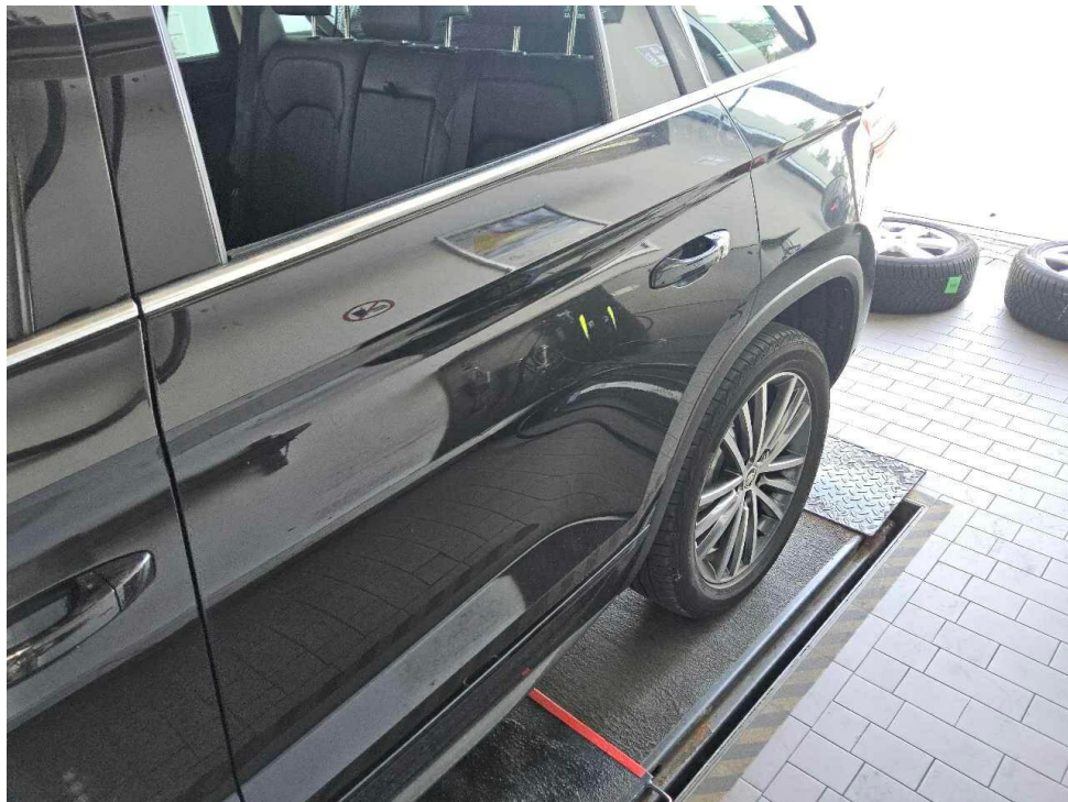
Bild 17 : Tür hinten links, eingedellt, drücken
