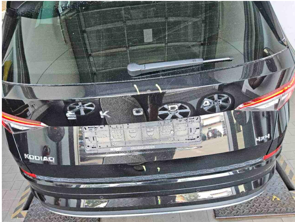
Bild 21 : Heckklappe, eingedellt, instandsetzen und lackieren mit Lackaufbau
