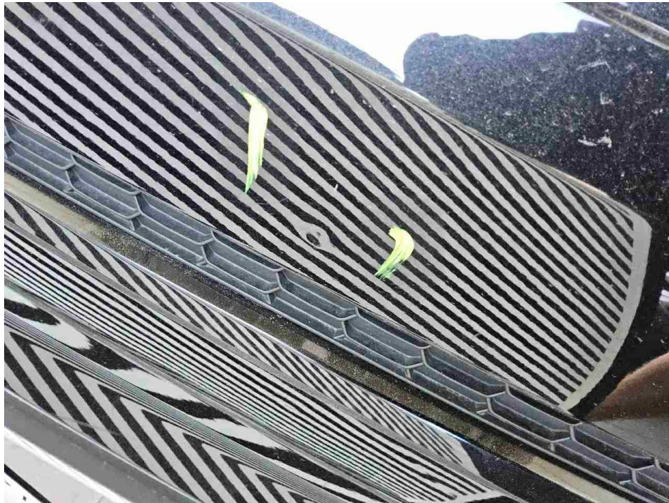
Bild 23 : Heckklappe, eingedellt, instandsetzen und lackieren mit Lackaufbau
