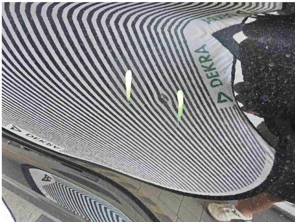
Bild 18 : Tür hinten links, eingedellt, drücken
