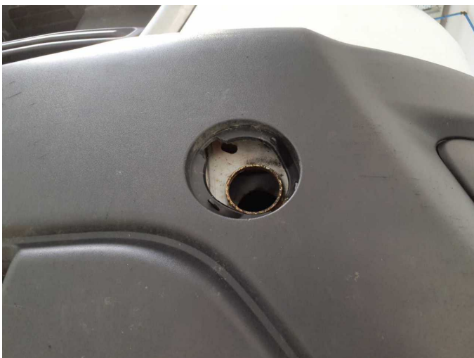
Damage 10: Front bumper: Front bumper (Zusätzlich lose & Abdeckkappe Abschleppöse fehlt) - Scratch(es) - Replace
