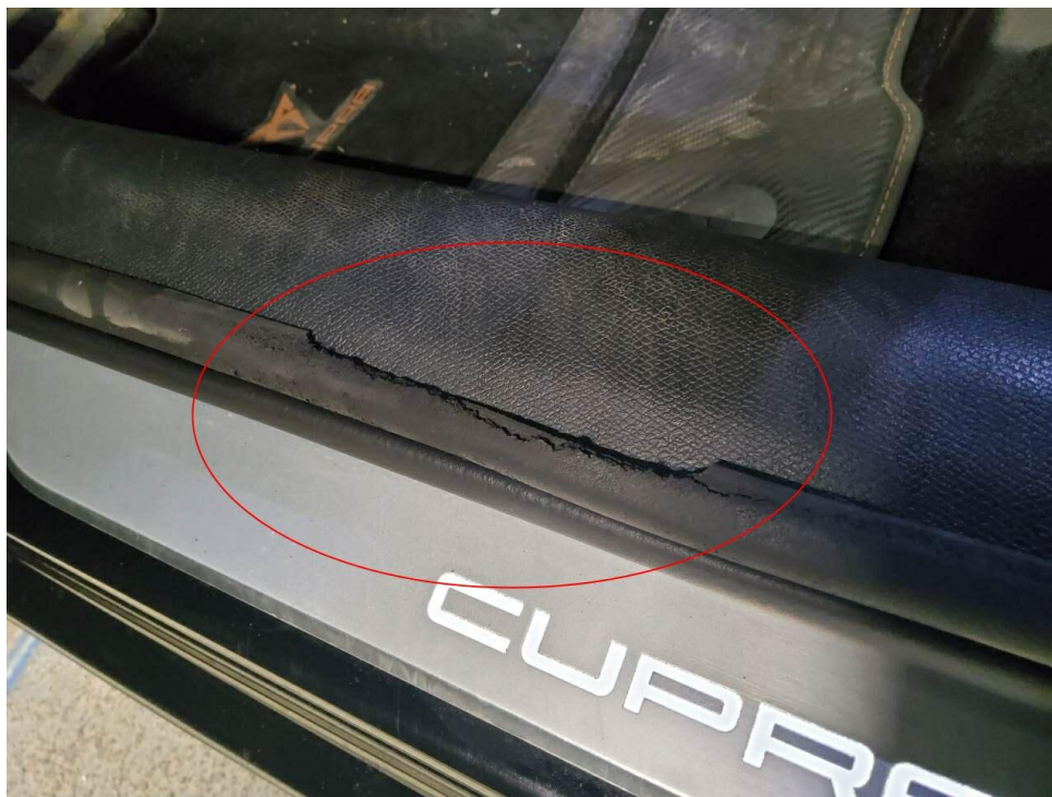
Bild 22 : Dichtung Einstieg vorne links, beschädigt
