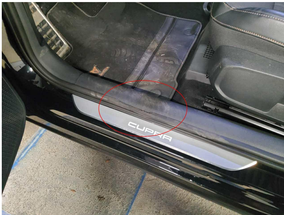
Bild 21 : Dichtung Einstieg vorne links, beschädigt
