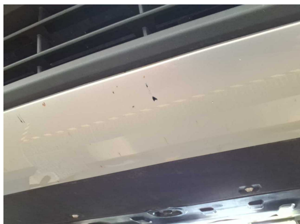
Beschädigung #1: Stossfänger vorn: Spoiler - Kratzer - Smart Repair
