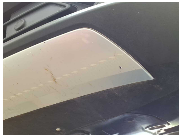
Beschädigung #1: Stossfänger vorn: Spoiler - Kratzer - Smart Repair
