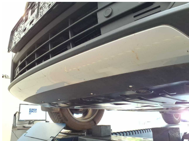
Beschädigung #1: Stossfänger vorn: Spoiler - Kratzer - Smart Repair
