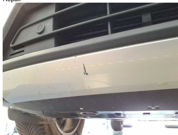
Beschädigung #1: Stossfänger vorn: Spoiler - Kratzer - Smart Repair
