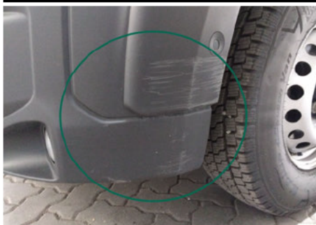
Stoßfänger / Vorne Links / Kratzer
