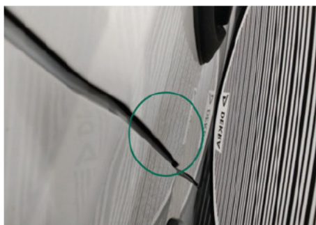
Heckklappe / Kofferraumtür / Unten Rechts / Delle
