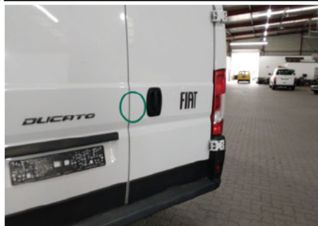
Heckklappe / Kofferraumtür / Unten Rechts / Delle
