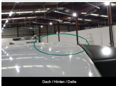
Dach / Hinten / Delle
