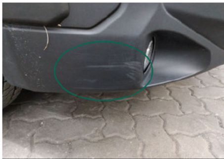
Stoßfänger / Vorne Rechts / Kratzer
