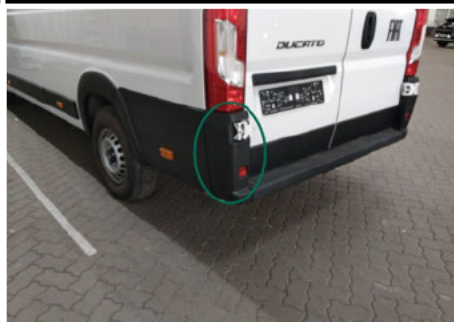
Stoßfänger / Hinten Links / Kratzer
