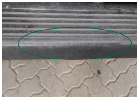
Stoßfänger / Hinten / Kratzer
