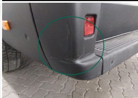
Stoßfänger / Hinten Links / Kratzer
