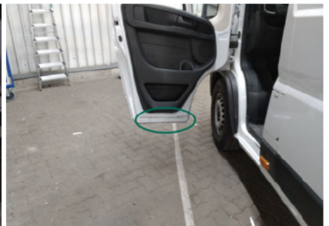
Tür / Innenraum Vorne Links / Abgewetzt
