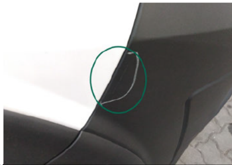
Stoßfänger / Vorne Rechts / Kratzer
