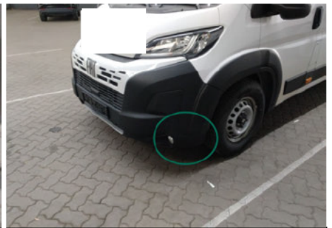
Stoßfänger / Vorne Links / Kratzer
