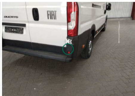
Stoßfänger / Hinten Rechts / Kratzer
