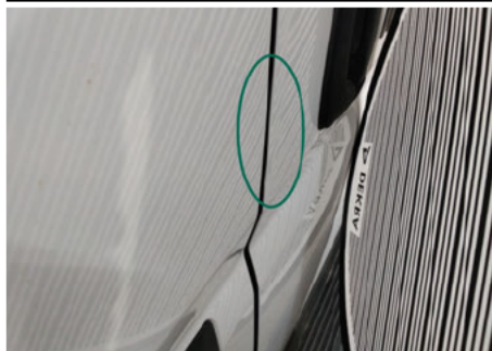
Heckklappe / Kofferraumtür / Unten Rechts / Delle
