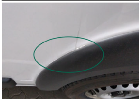
Seitenwand / Hinten Links / Schlecht Repariert
