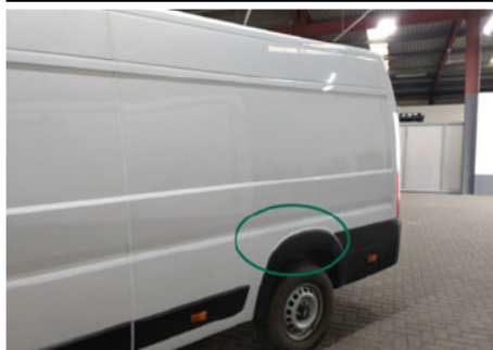
Seitenwand / Hinten Links / Schlecht Repariert
