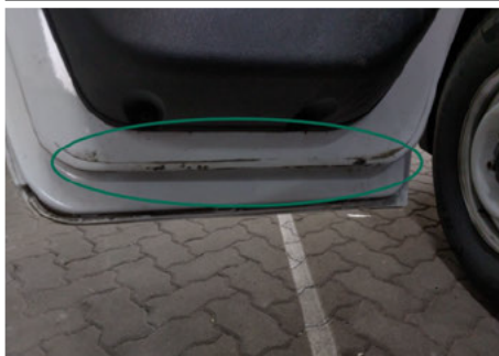
Tür / Innenraum Vorne Links / Abgewetzt
