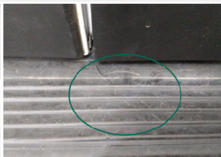
Stoßfänger / Hinten / Kratzer
