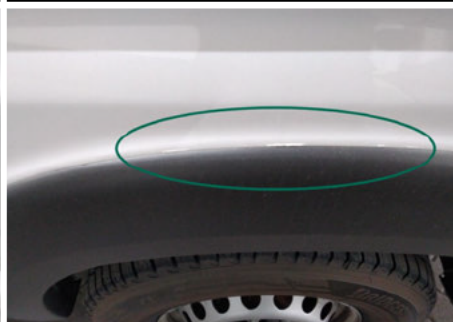
Seitenwand / Hinten Links / Schlecht Repariert
