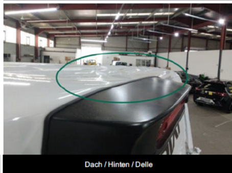
Dach / Hinten / Delle
