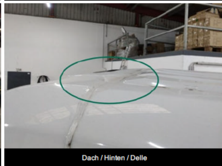
Dach / Hinten / Delle
