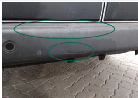
Stoßfänger / Hinten / Kratzer
