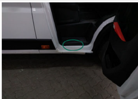
Türeinstieg / Vorne Rechts / Abgewetzt
