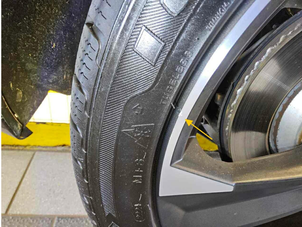
Bild 18 : Leichtmetallfelge hinten rechts, zerkratzt
