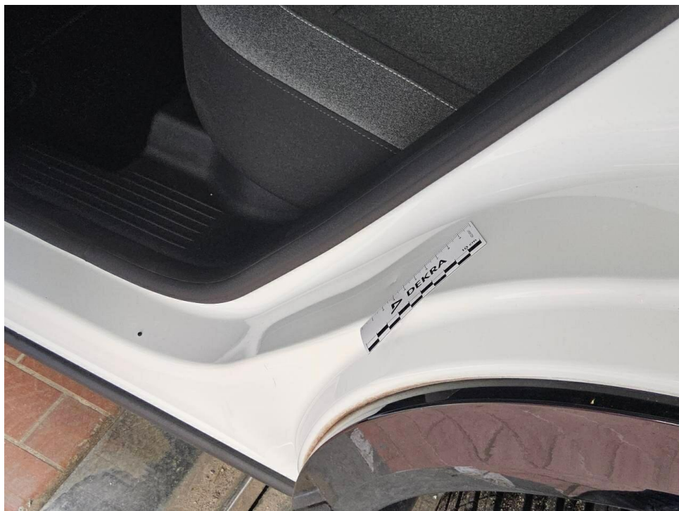
Bild 10 : Tür hinten links Einstieg, eingedellt
