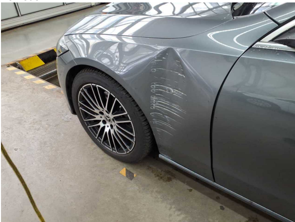
Beschädigung #6: Kotflügel links: Kotflügel links - verformt - erneuern
