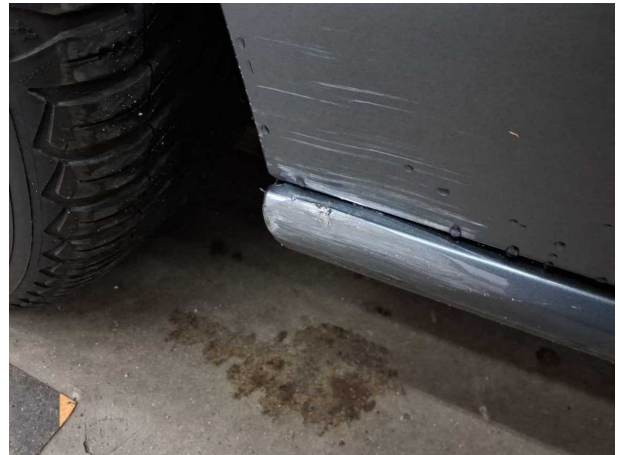
Beschädigung #5: Schweller links: Verkleidung - gebrochen / gerissen - erneuern
