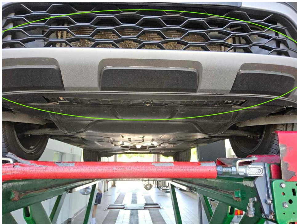
Bild 19 : Stoßfängerverkleidung vorne vieleSteinschläge
