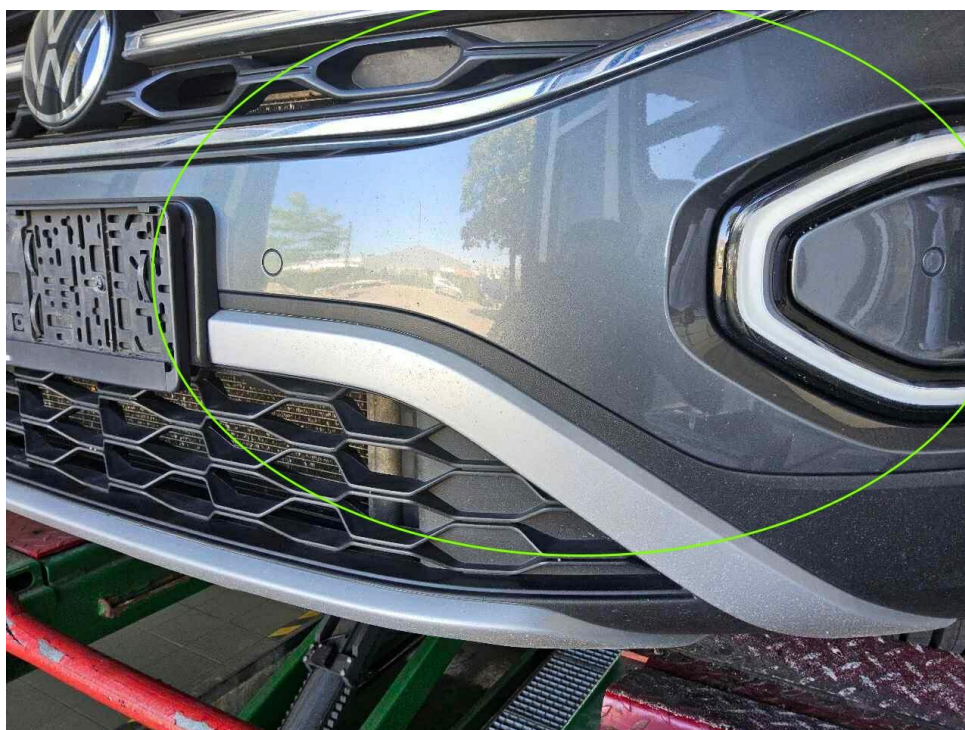
Bild 22 : Stoßfängerverkleidung vorne Steinschläge
