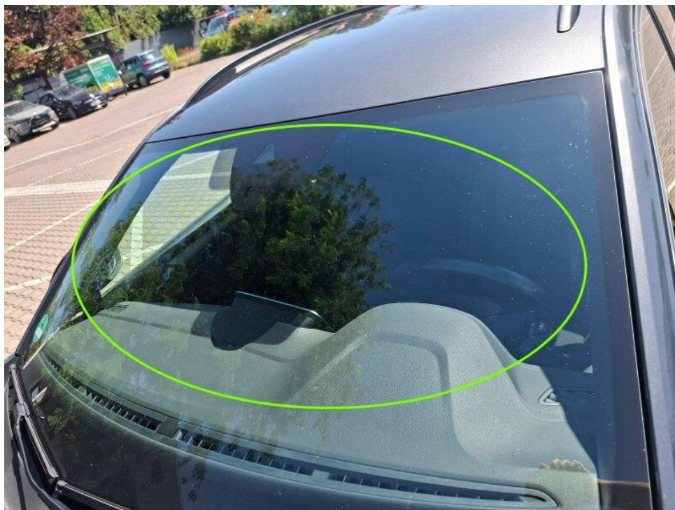
Bild 15 : Frontscheibe viele Steinschläge (Sichtbeeinträchtigung)
