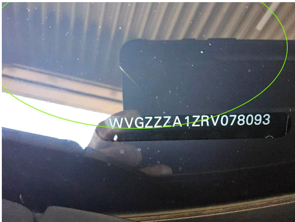
Bild 17 : Frontscheibe viele Steinschläge (Sichtbeeinträchtigung)
