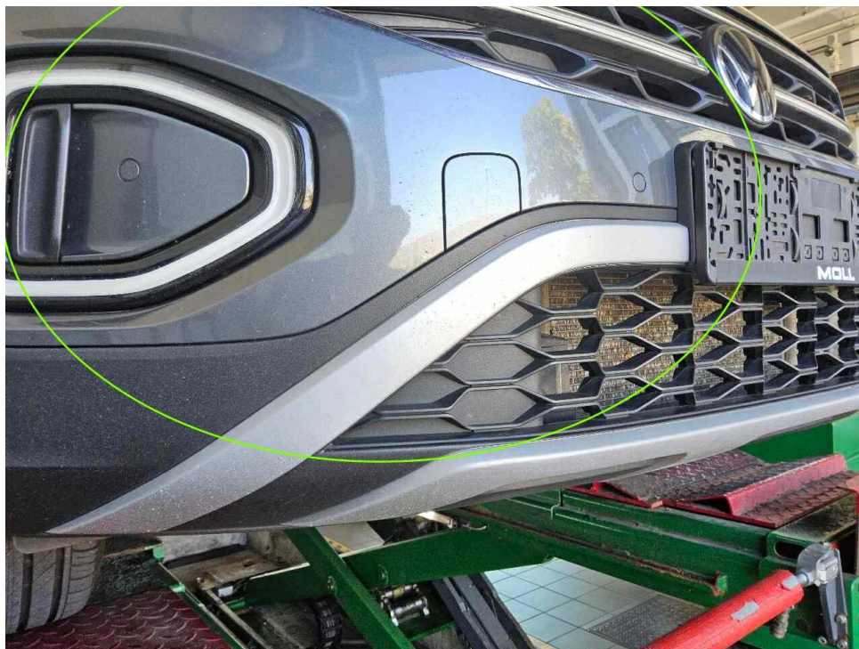
Bild 23 : Stoßfängerverkleidung vorne Steinschläge
