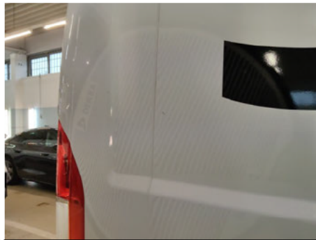
Seitenwand / Hinten Rechts / Delle
