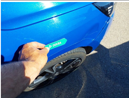
Aleta / Delantero Derecho / Abolladura
