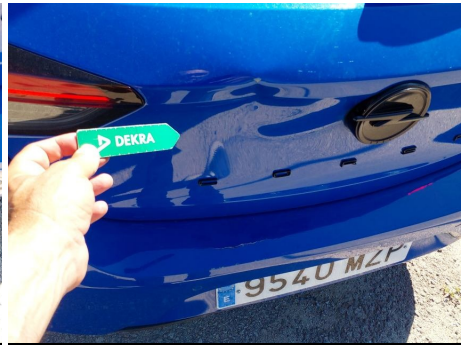
Portón trasero / puerta del maletero / - / Abolladura
