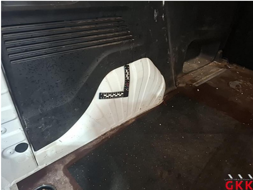
Bild 30. Radhaus hinten links, verkratzt, lackieren
