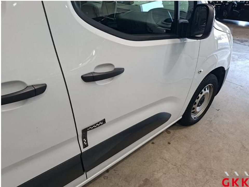
Bild 39. Tür vorne rechts, verkratzt, Smartrepair
