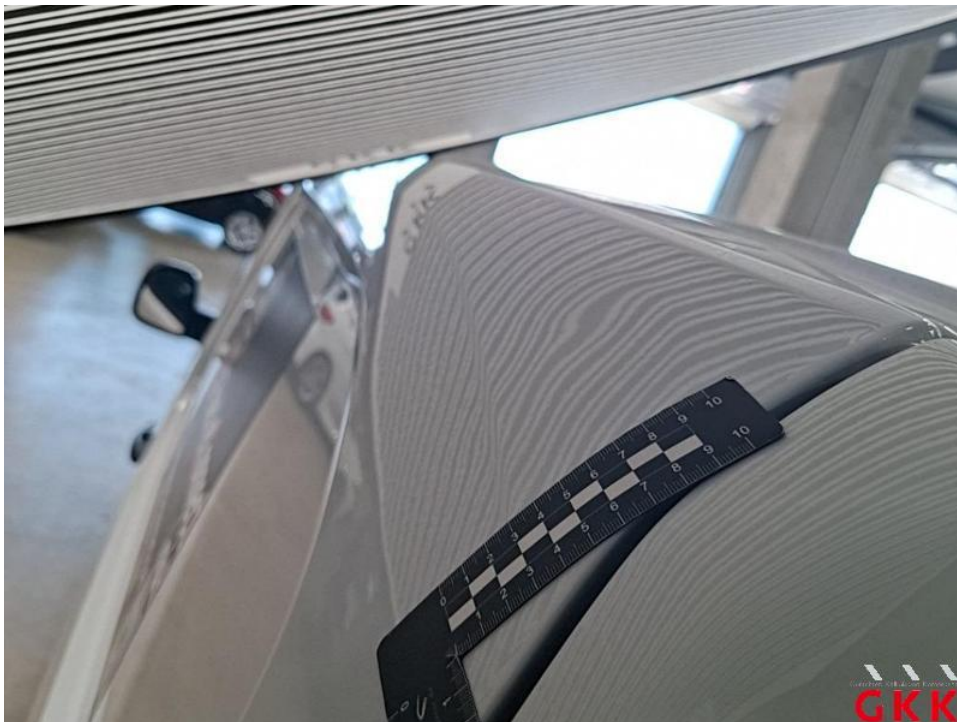
Bild 47. Seitenwand links, bis 3 Dellen / Bauteil, kalt drücken
