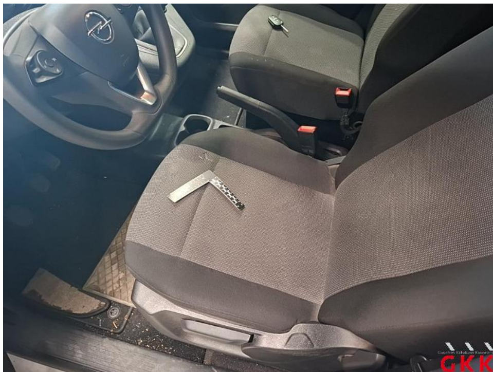
Bild 21. Sitz vorne links, Bezug Sitzkissen -Stoff-, beschädigt, ersetzen
