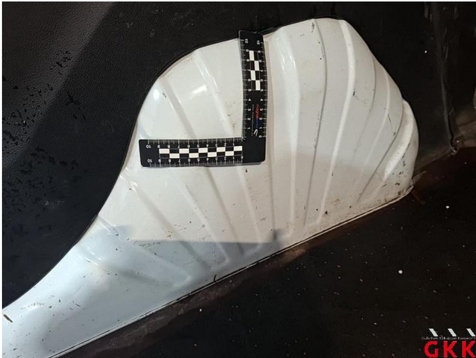
Bild 31. Radhaus hinten links, verkratzt, lackieren
