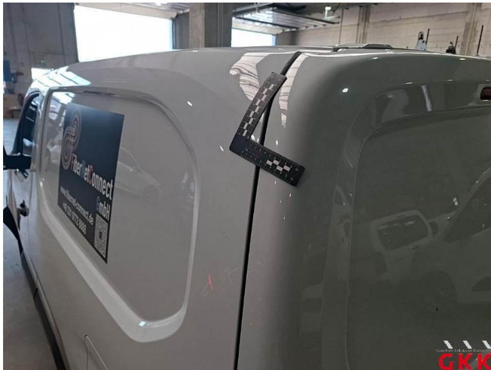
Bild 46. Seitenwand links, bis 3 Dellen / Bauteil, kalt drücken
