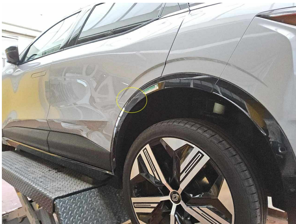
Bild 11 : Radlaufblende hinten links, zerkratzt
