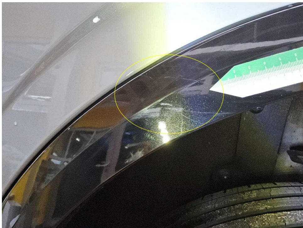
Bild 12 : Radlaufblende hinten links, zerkratzt
