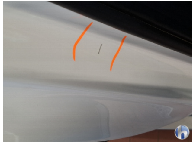
2. Türeinstieg Hinten - Rechts Beschädigt - Smart Repair
