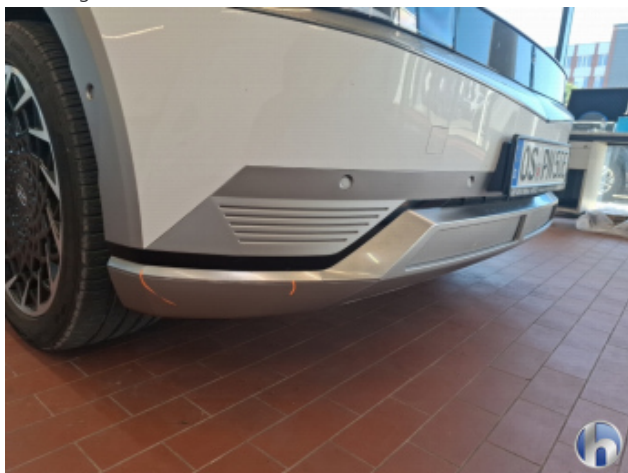
1. Frontspoiler Abschürfung - Smart Repair
