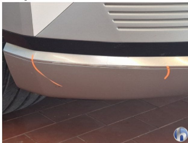
1. Frontspoiler Abschürfung - Smart Repair
