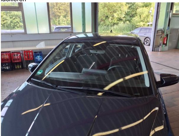
Beschädigung #5: Verglasung: Frontscheibe - Steinschlag - erneuern
