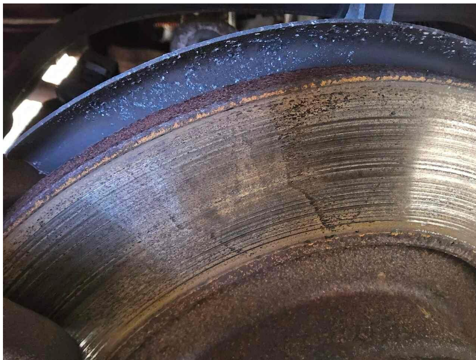
Bild 35 : Bremsscheiben Hinterachse Tragbild mangelhaft, Riefen-und Korrosionsbildung
