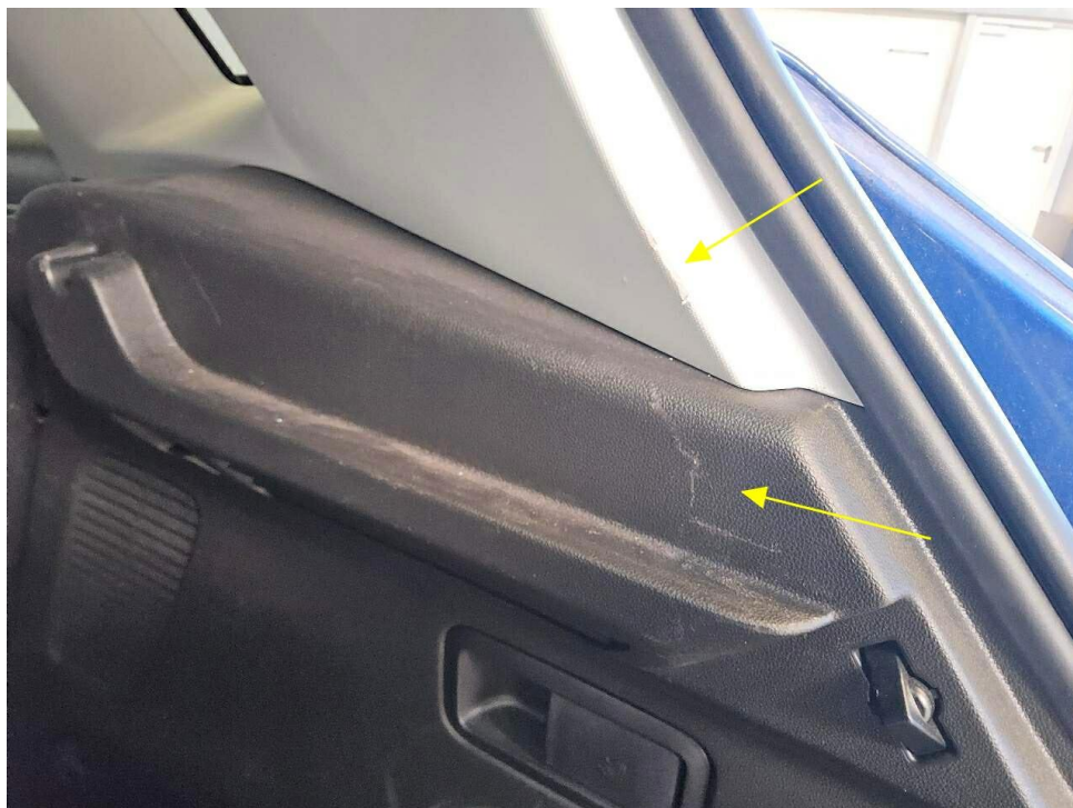
Bild 44 : Verkleidung Laderaum rechts verschrammt
