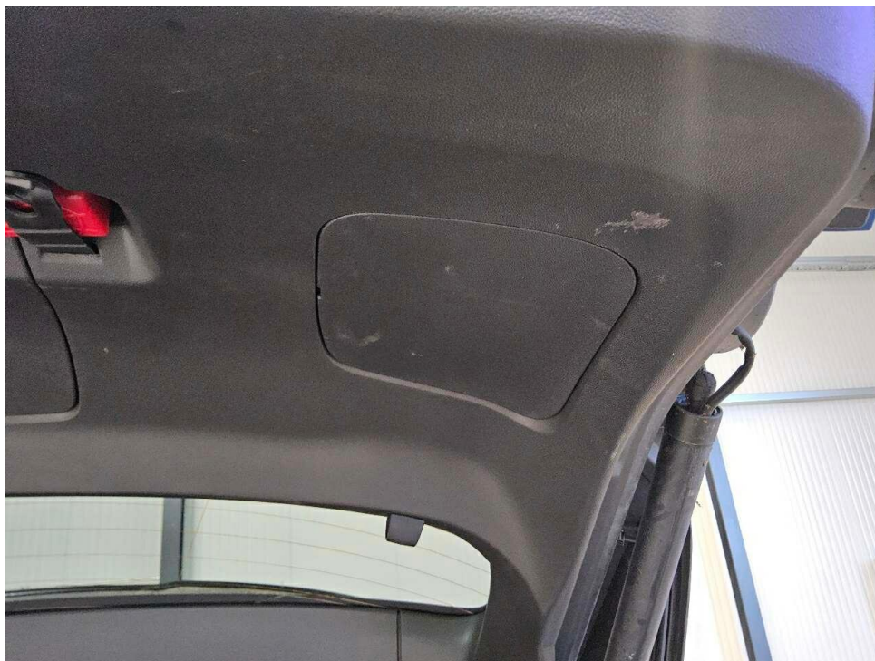
Bild 41 : Verkleidung Heckklappe verschrammt
