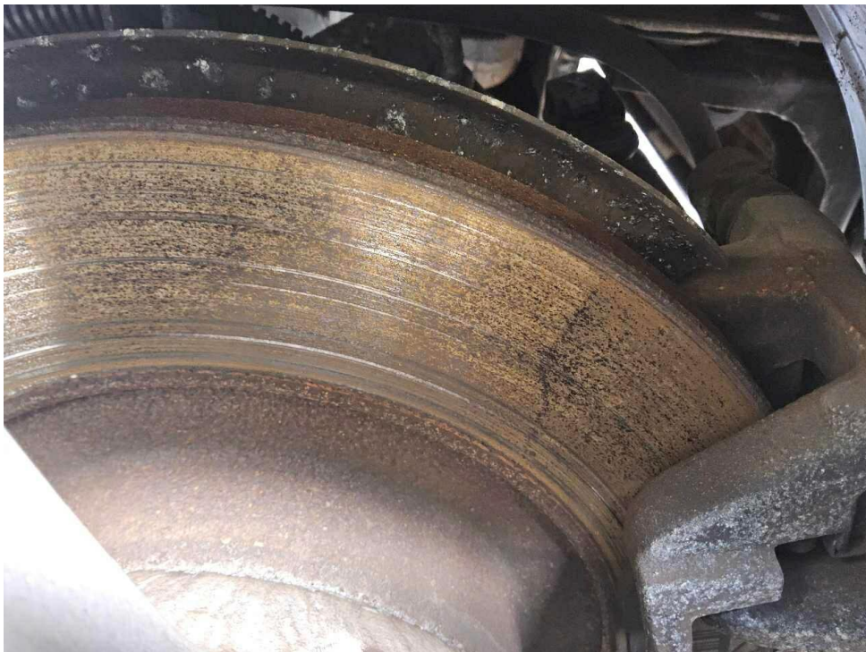
Bild 34 : Bremsscheiben Hinterachse Tragbild mangelhaft, Riefen-und Korrosionsbildung
