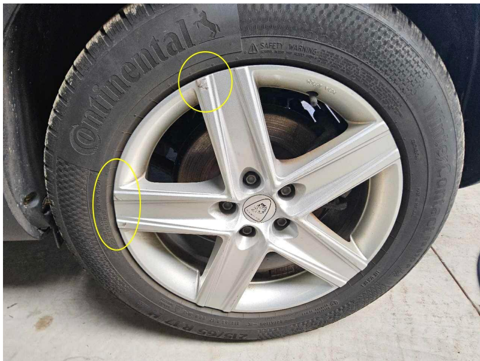
Bild 38 : Leichtmetallfelge Winterrad hinten links verschrammt
