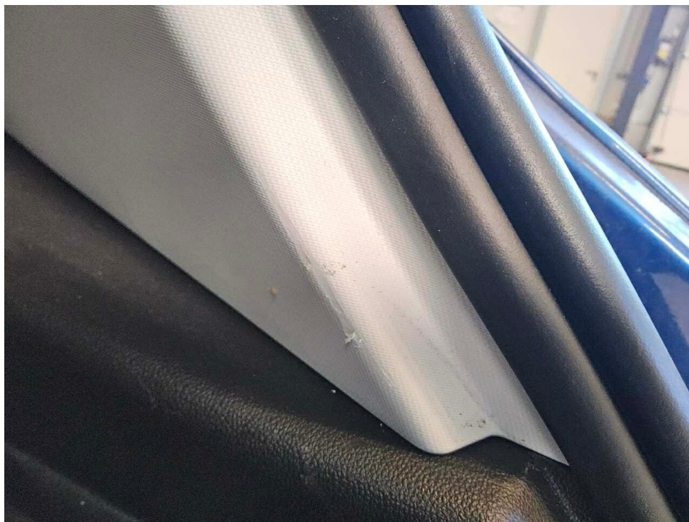
Bild 46 : Verkleidung Laderaum rechts verschrammt
