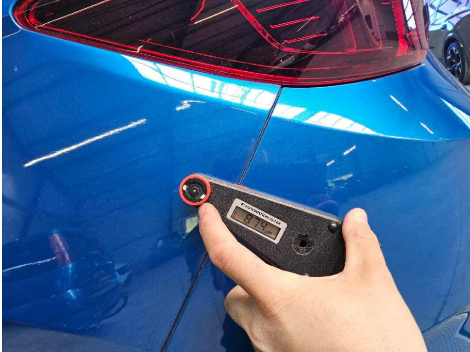
Bild 17 : Seitenwand hinten links erhöhte Lackschichtdicke
