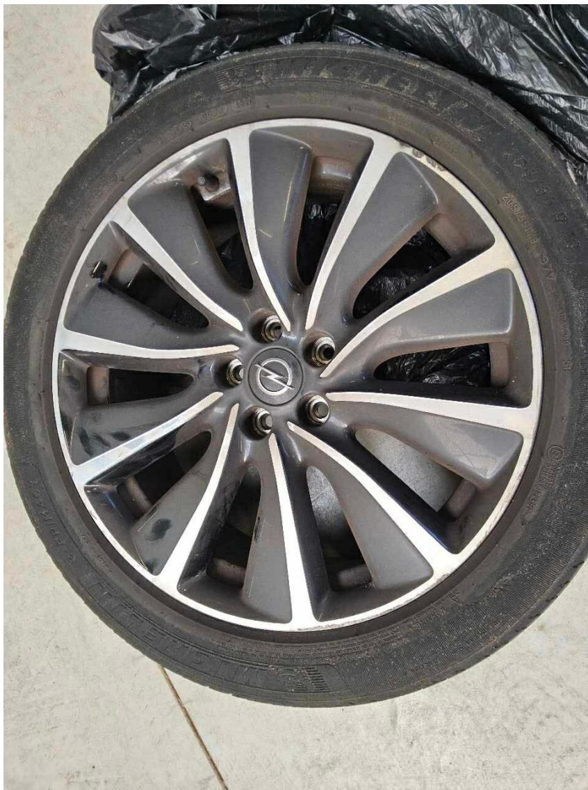
Bild 18 : Glanzgedrehte Leichtmetallfelge vorne rechts verschrammt, Materialabtrag >1mm
