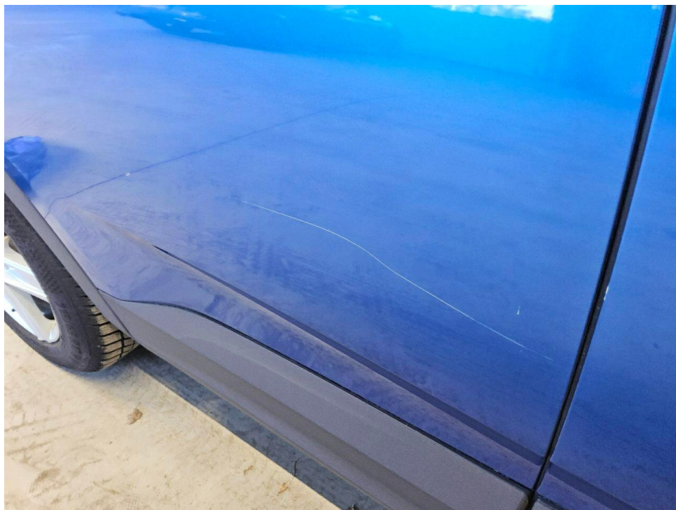
Bild 29 : Tür hinten rechts verschrammt
