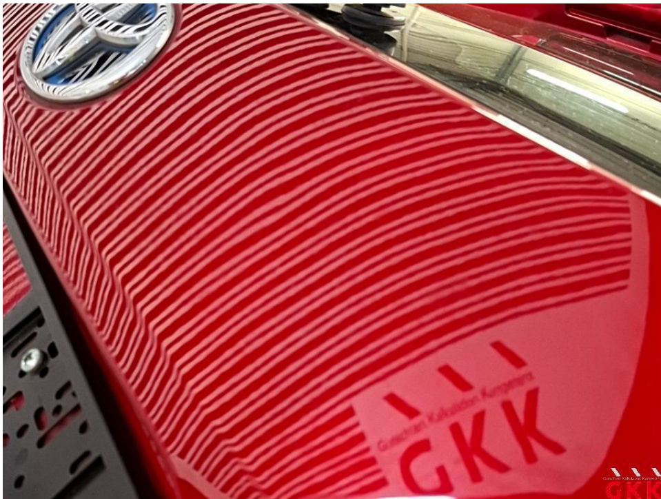
Bild 36 Heckklappe, beschädigt, instand setzen - lackieren
