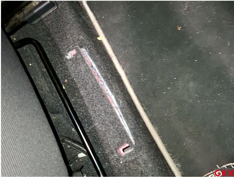
Bild 19 Abdeckung VIN, fehlt, ersetzen
