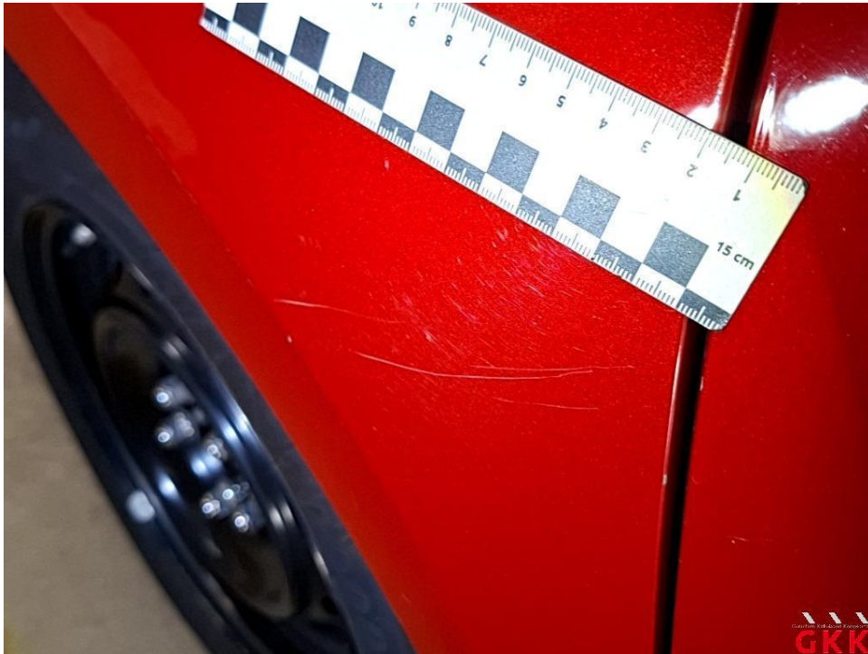
Bild 43 Seitenwand rechts, verkratzt, lackieren
