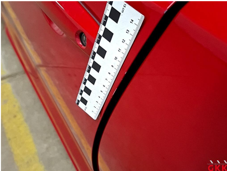
Bild 26 Tür vorne links, Kante, verkratzt, Smartrepair
