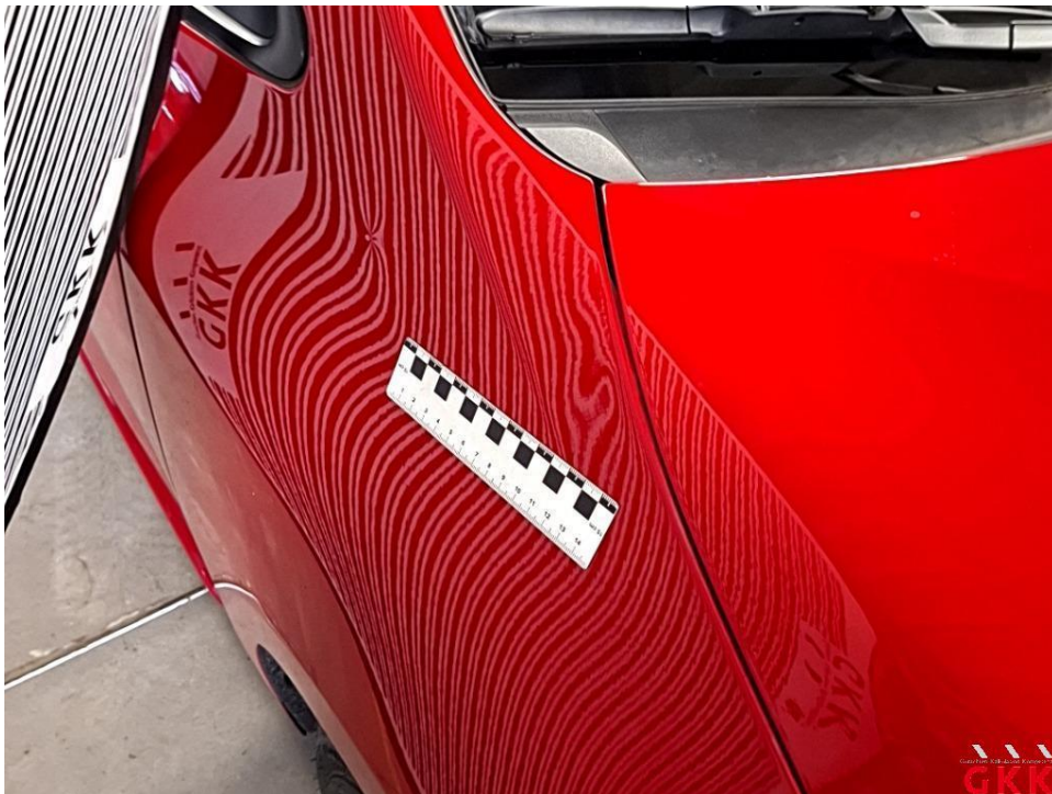
Bild 20 Kotflügel vorne links, beschädigt, ersetzen
