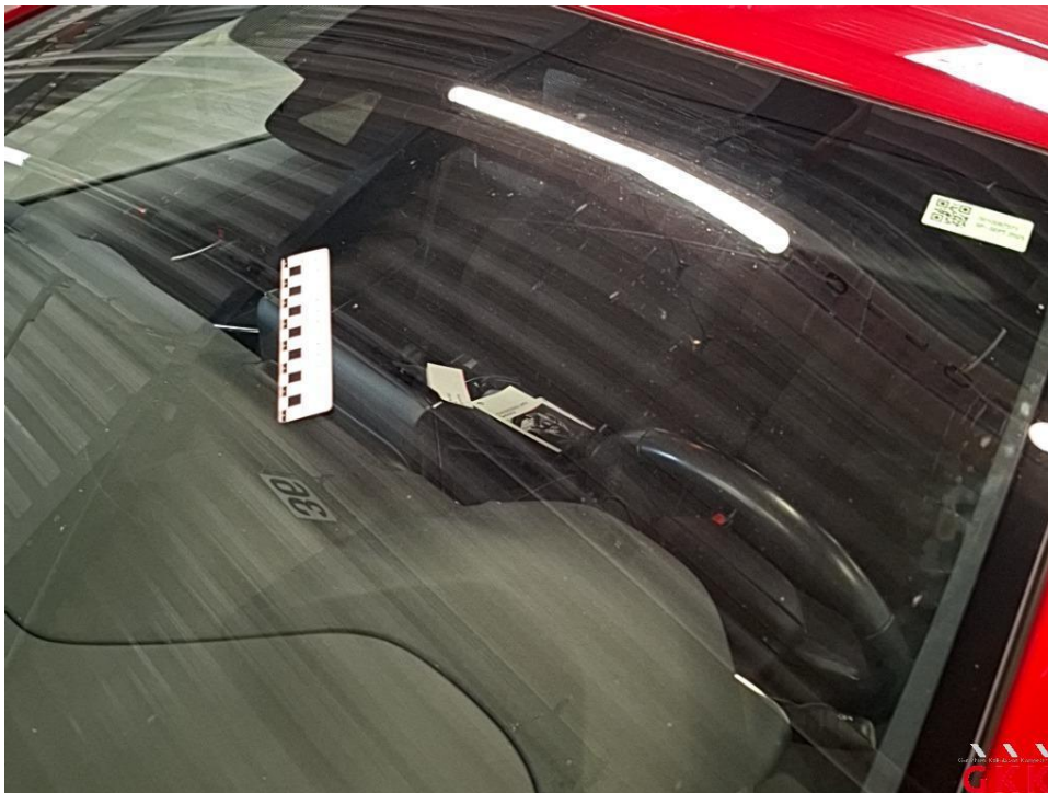
Bild 46 Frontscheibe, mit Regensensor und Frontkamera, Steinschlag im Sichtfeld, ersetzen
