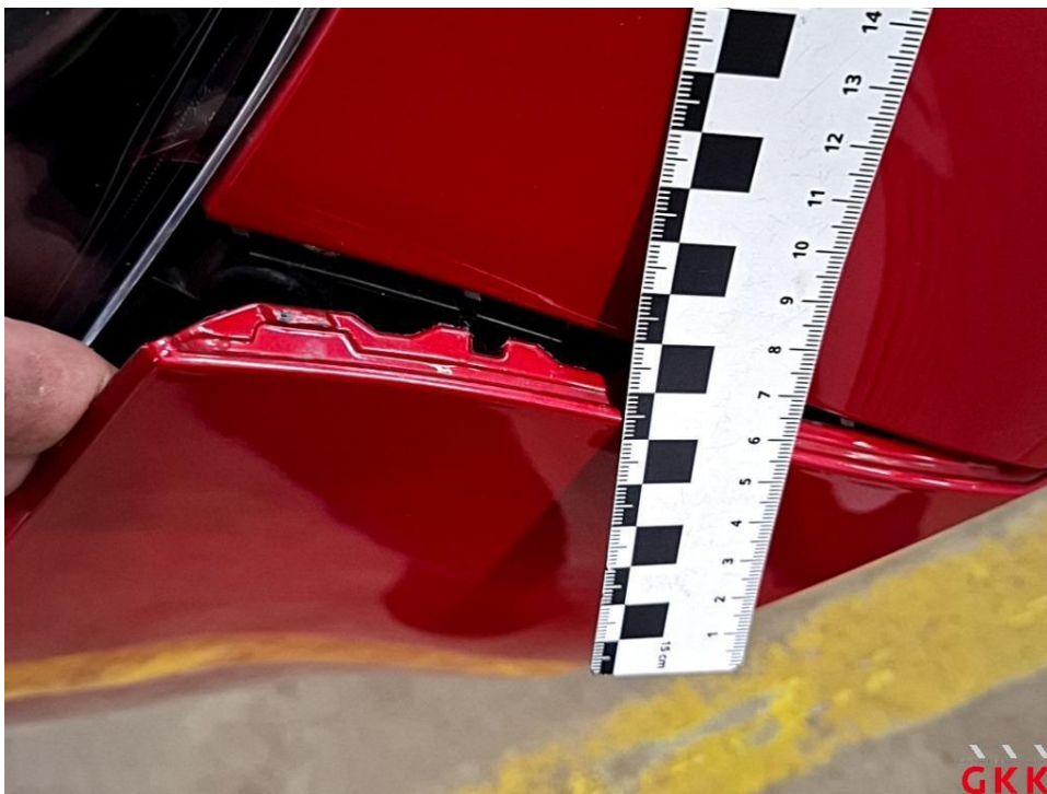
Bild 24 Stoßfänger vorne, Verkleidung -lackiert-, beschädigt, ersetzen
