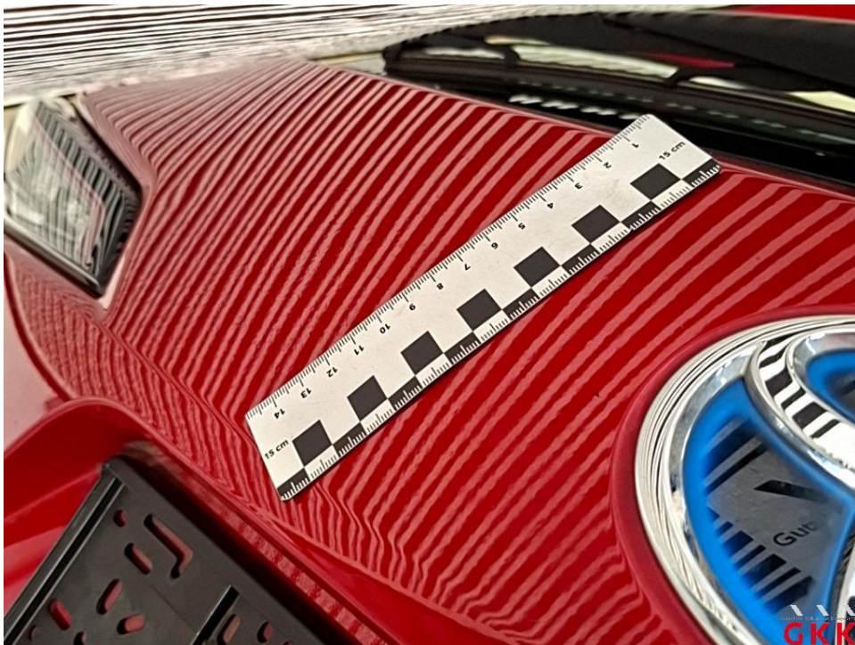
Bild 38 Heckklappe, beschädigt, instand setzen - lackieren
