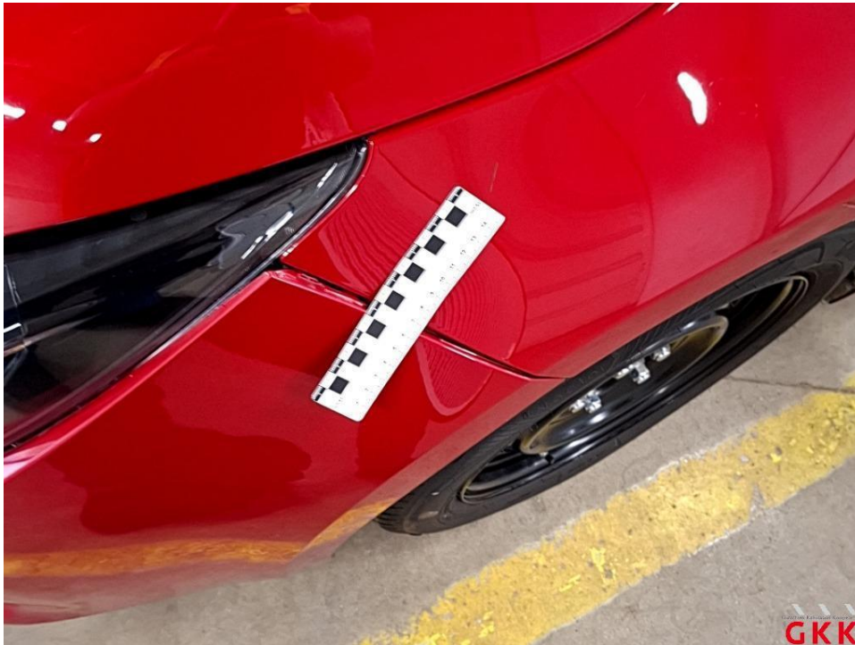
Bild 23 Stoßfänger vorne, Verkleidung -lackiert-, beschädigt, ersetzen
