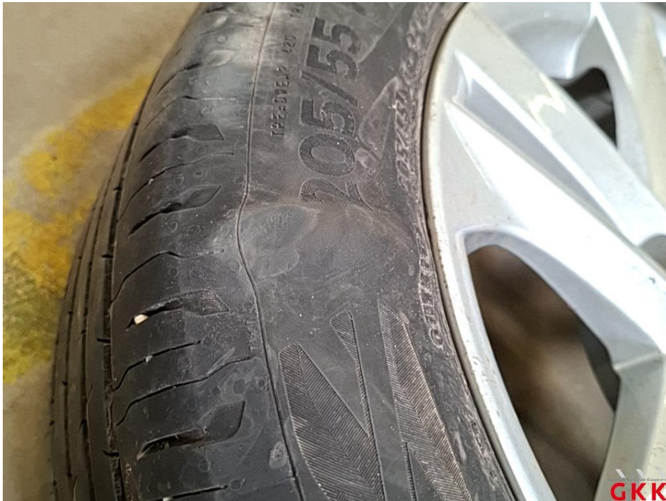
Bild 49 Reifen, 1 x beiliegend, beschädigt, ersetzen
