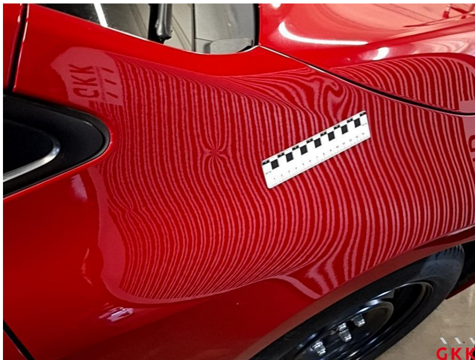
Bild 22 Kotflügel vorne links, beschädigt, ersetzen
