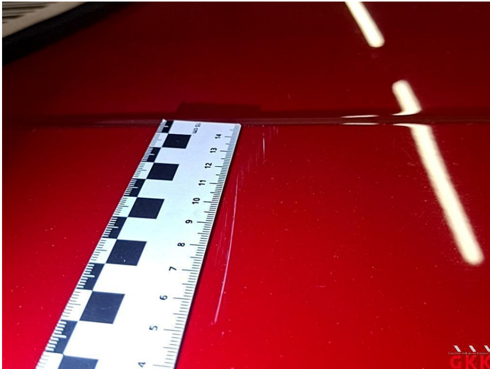
Bild 41 Dach, verkratzt, lackieren
