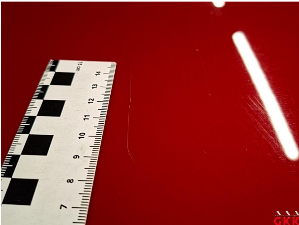
Bild 40 Dach, verkratzt, lackieren
