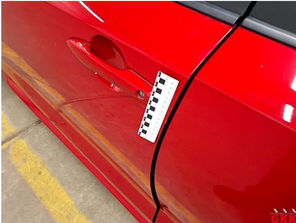
Bild 25 Tür vorne links, Kante, verkratzt, Smartrepair
