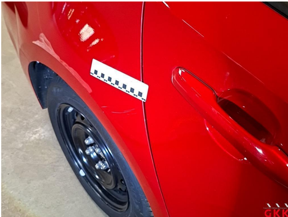
Bild 42 Seitenwand rechts, verkratzt, lackieren
