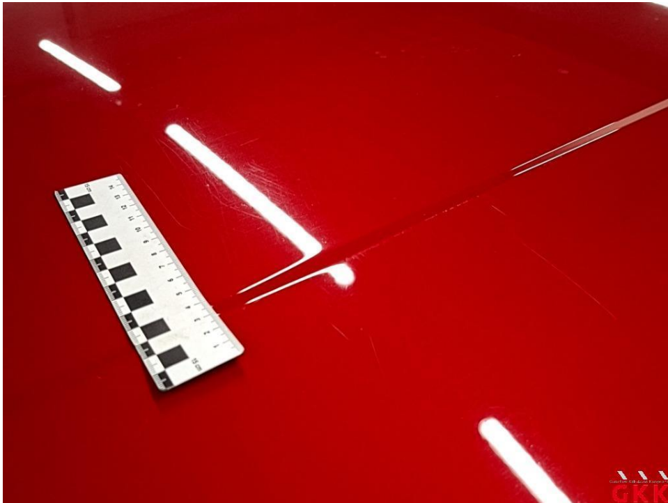
Bild 39 Dach, verkratzt, lackieren
