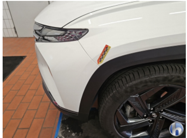
2. Stoßfänger Vorne Spaltmaß Ungenau - Nacharbeiten
