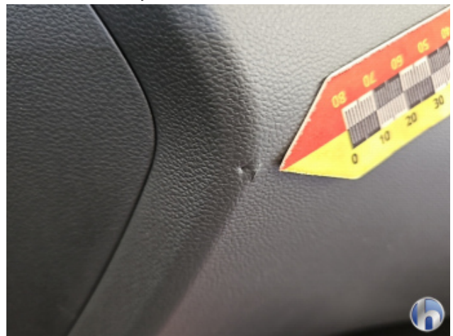
5. Türverkleidung Vorne - Rechts Verformt - Smart Repair
