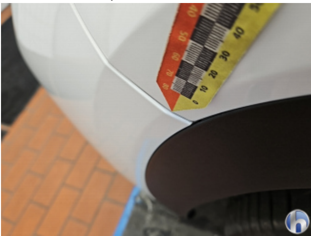
2. Stoßfänger Vorne Spaltmaß Ungenau - Nacharbeiten
