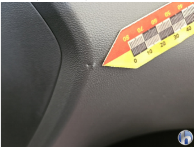
5. Türverkleidung Vorne - Rechts Verformt - Smart Repair
