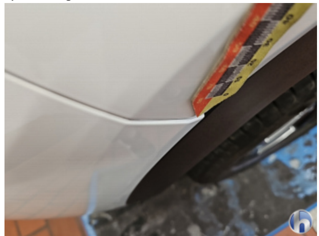
2. Stoßfänger Vorne Spaltmaß Ungenau - Nacharbeiten
