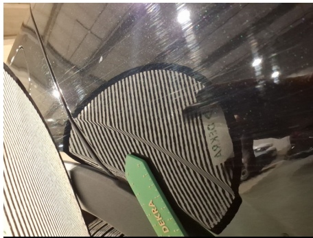
Porte / Arrière Droit / Enfoncement
