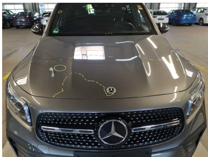
Damage 12: Bonnet: Bonnet (Sandstrahleffekt) - Stone chips - Paint
