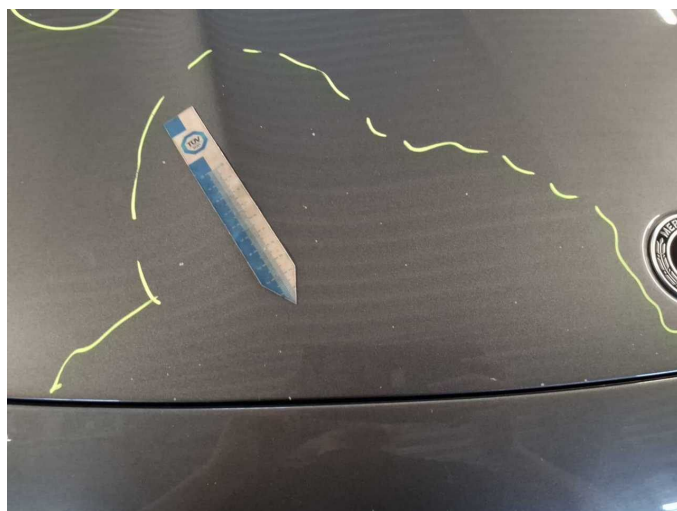
Damage 12: Bonnet: Bonnet (Sandstrahleffekt) - Stone chips - Paint
