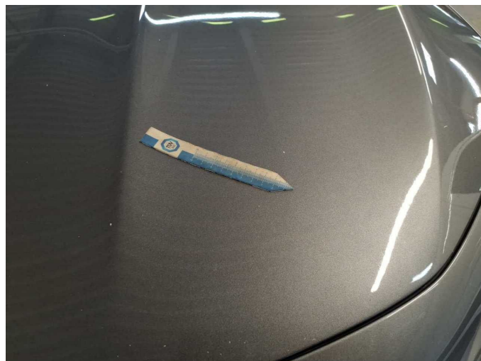
Damage 12: Bonnet: Bonnet (Sandstrahleffekt) - Stone chips - Paint
