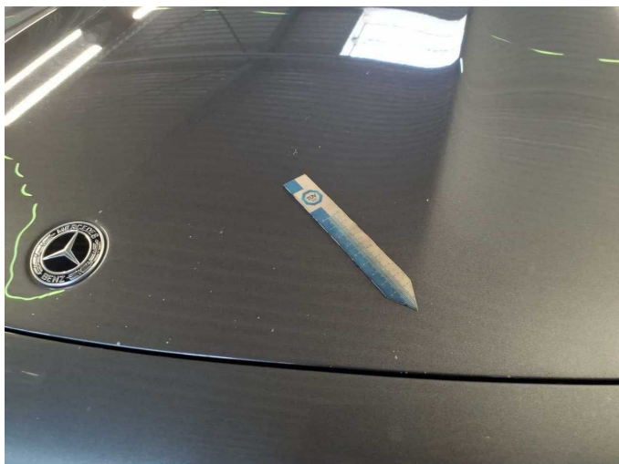
Damage 12: Bonnet: Bonnet (Sandstrahleffekt) - Stone chips - Paint
