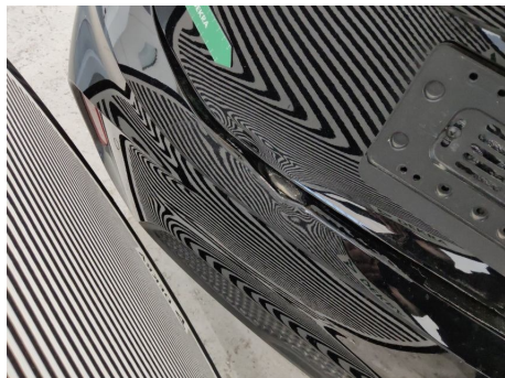
Heckklappe / Kofferraumtür / - / Delle
