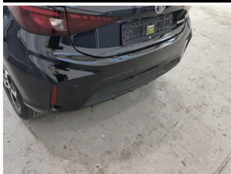
Stoßfänger / Hinten / Gebrochen
