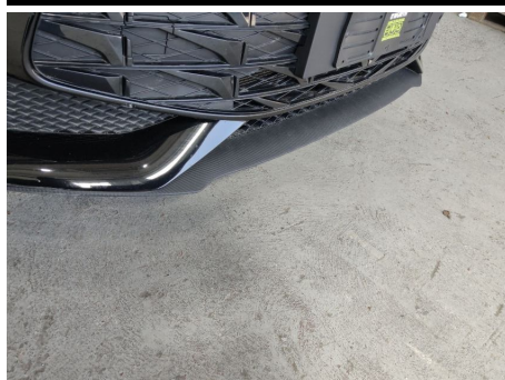
Spoiler / Vorne / Gebrochen
