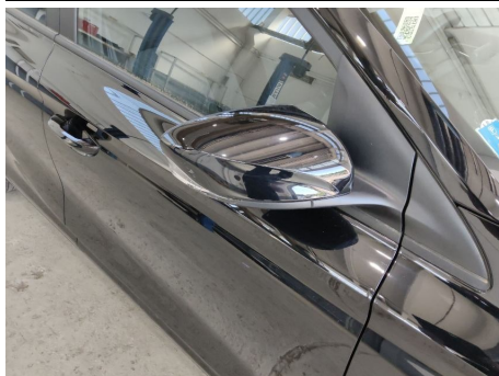
Außenspiegelkappe / Rechts / Kratzer
