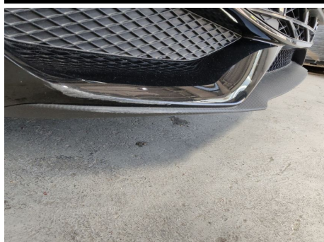
Spoiler / Vorne / Gebrochen
