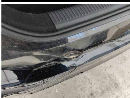
Stoßfänger / Hinten / Gebrochen
