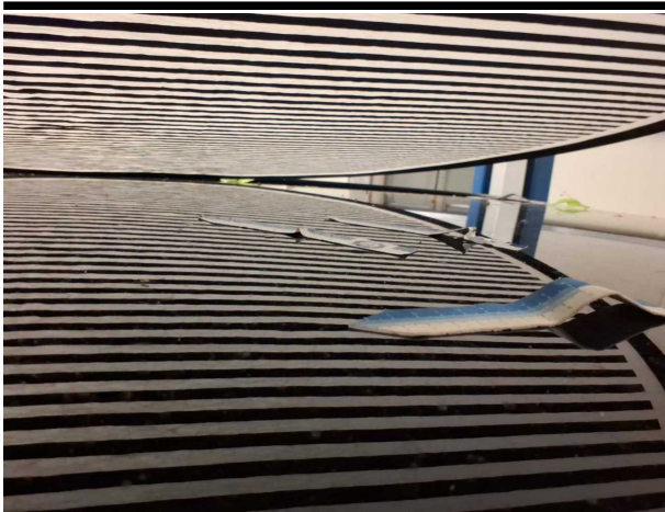
Beschädigung #2: Fahrzeugdach: Dach - Delle / Lackschaden - instandsetzen und lackieren
