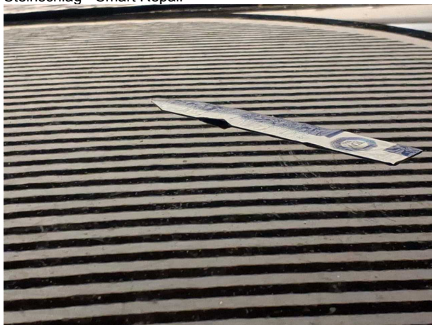
Beschädigung #2: Fahrzeugdach: Dach - Delle / Lackschaden - instandsetzen und lackieren
