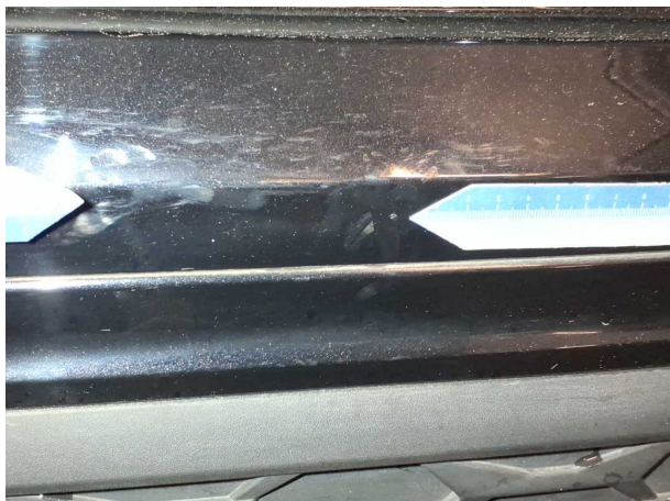
Beschädigung #1: Stossfänger hinten: Stossfänger hinten - Steinschlag - Smart Repair
