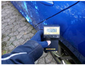
Lackstärke Seitenwand hinten links
