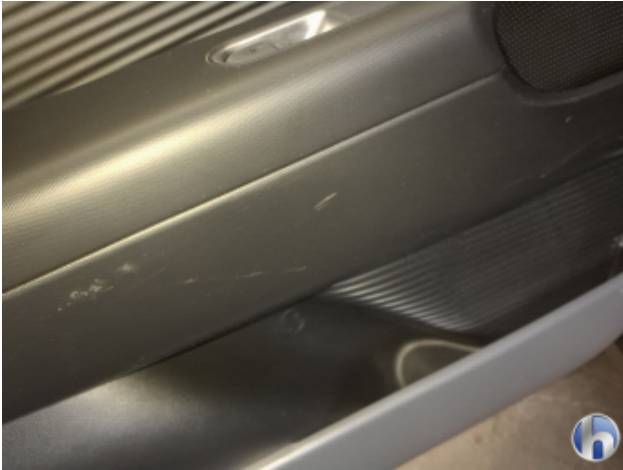
4. Verkleidung Verschmutzt - Reinigen
