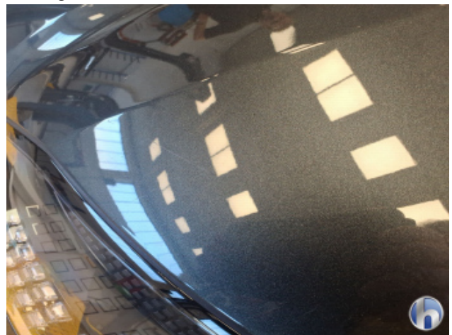
2. Motorhaube Oberflächenkratzer - Aufbereiten / Polieren
