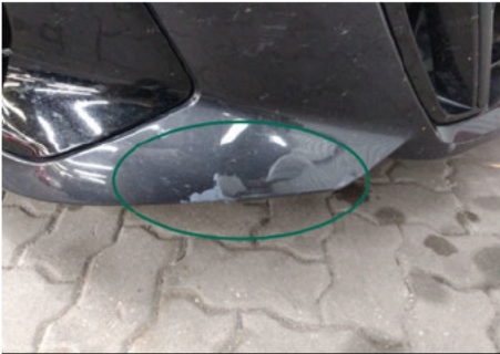
Stoßfänger / Vorne / Delle
