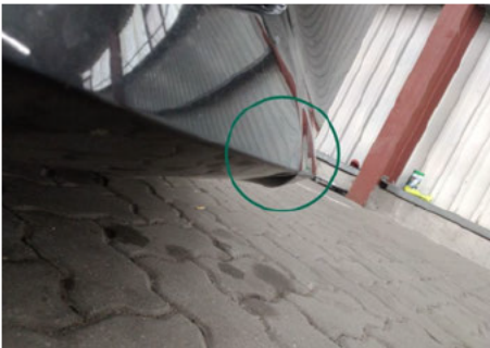
Stoßfänger / Vorne / Delle
