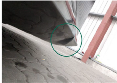
Stoßfänger / Vorne / Delle
