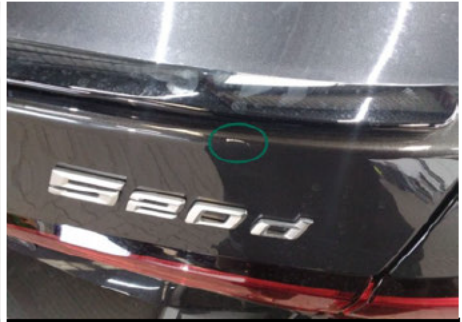
Heckklappe / Kofferraumtür / Oben Oben / Kratzer
