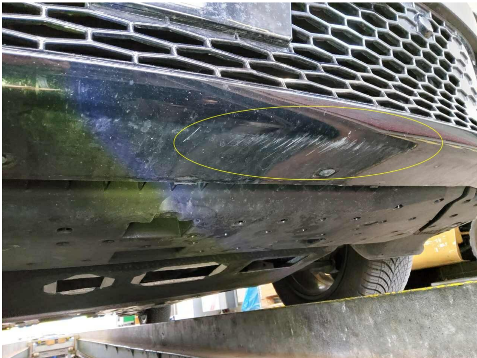
Bild 16 : Frontspoiler, zerkratzt, lackieren mit Lackaufbau
