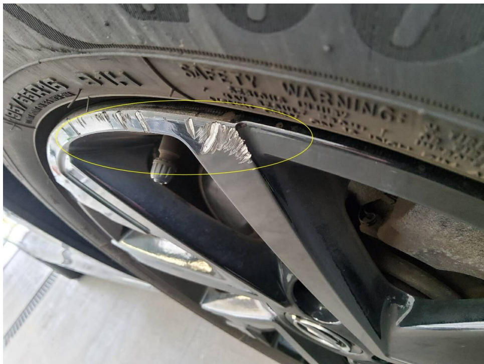
Bild 14 : Alufelge vorn rechts, Materialabtrag am Felgenhorn, örtlich begrenzt
