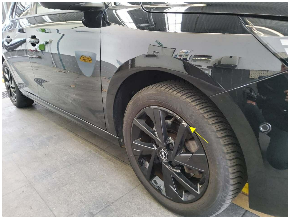
Bild 13 : Alufelge vorn rechts, Materialabtrag am Felgenhorn, örtlich begrenzt
