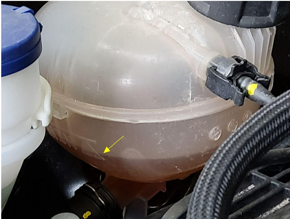
Bild 15 : Kühlwasser Motor, unter minimum
