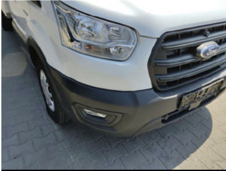
Stoßfänger / Vorne Rechts / Delle
