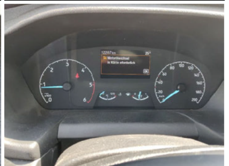
Warnleuchte Inspektion / Fehlt
