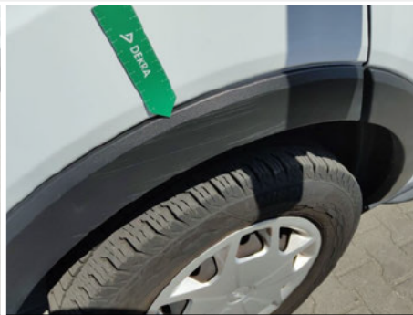
Kotflügelverbreiterung / Vorne Links / Kratzer
