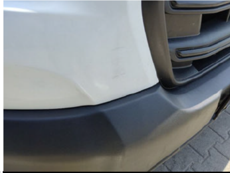
Stoßfänger / Vorne Rechts / Delle
