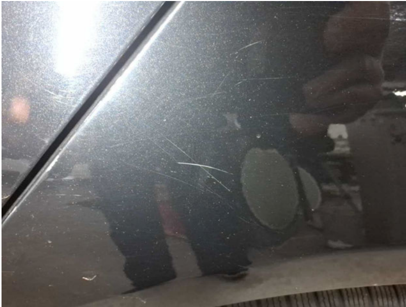
Beschädigung #9: Seitenwand links: Seitenwand - Kratzer - lackieren
