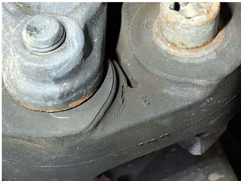
Beschädigung #6: Antriebsstrang: Gelenkwelle Hinterachse (Hardyscheibe) - porös / rissig - erneuern
