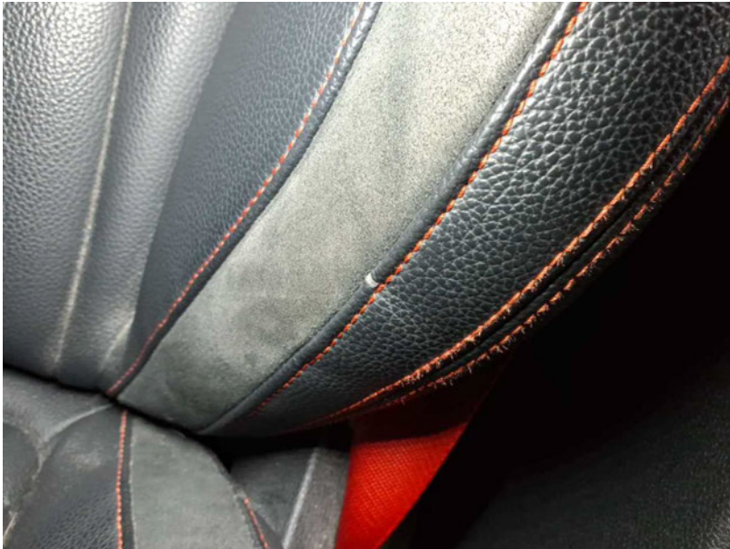
Beschädigung #5: Sitz vorn: Lehnenbezug links - gebrochen / gerissen - Smart Repair
