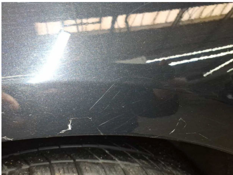
Beschädigung #9: Seitenwand links: Seitenwand - Kratzer - lackieren
