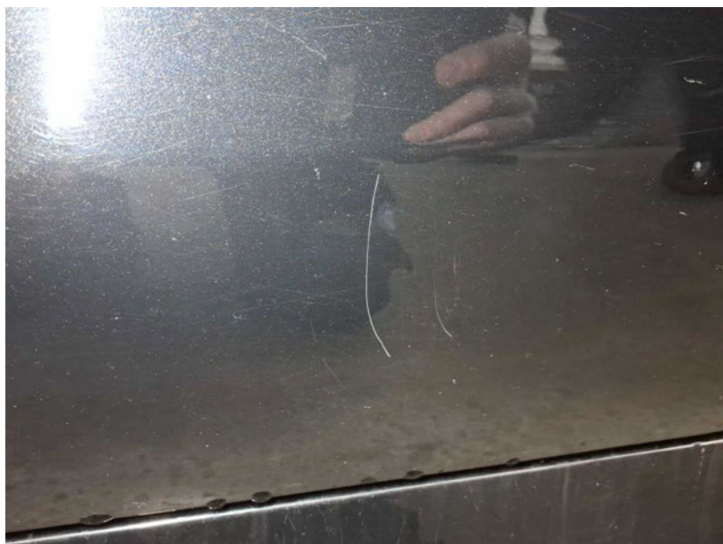
Beschädigung #13: Tür hinten links: Tür - Kratzer - lackieren
