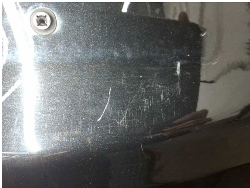
Beschädigung #15: Heckklappe/-tür: Heckklappe - Kratzer - lackieren
