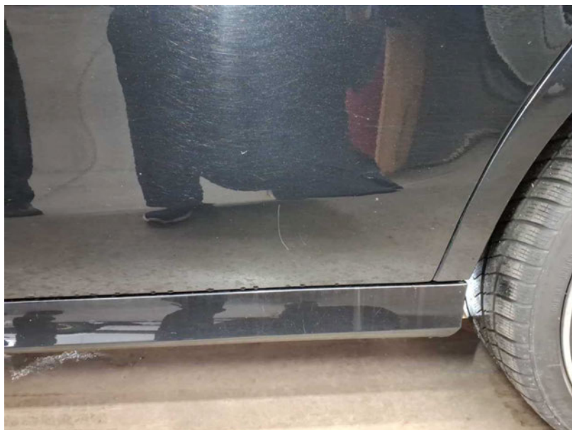
Beschädigung #13: Tür hinten links: Tür - Kratzer - lackieren
