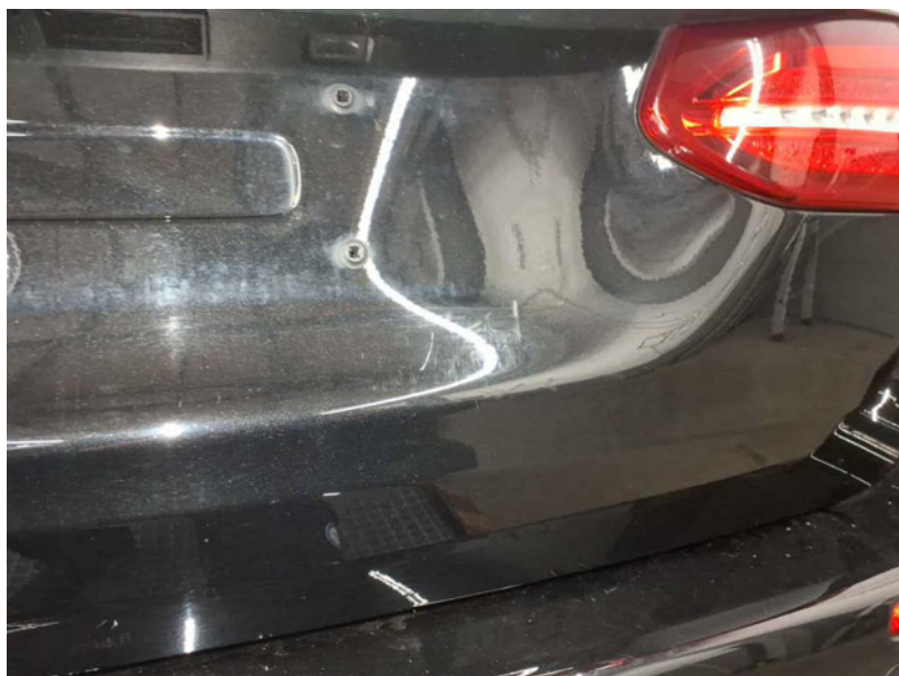
Beschädigung #15: Heckklappe/-tür: Heckklappe - Kratzer - lackieren
