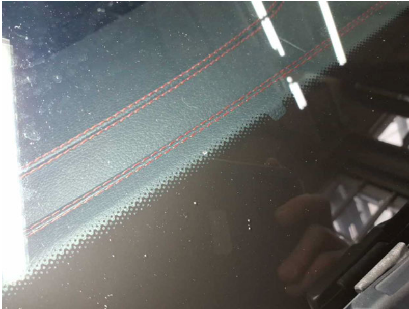
Beschädigung #23: Verglasung: Frontscheibe - Steinschlag - erneuern
