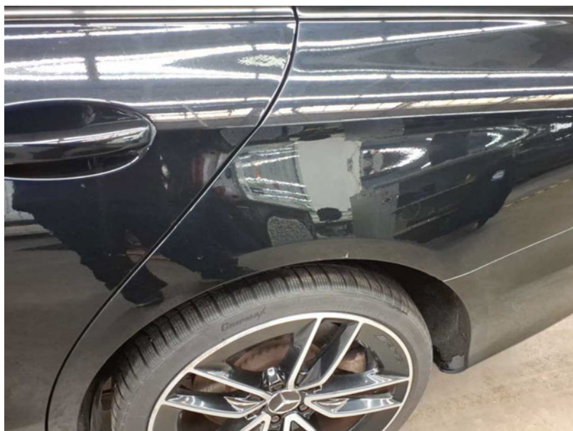
Beschädigung #9: Seitenwand links: Seitenwand - Kratzer - lackieren
