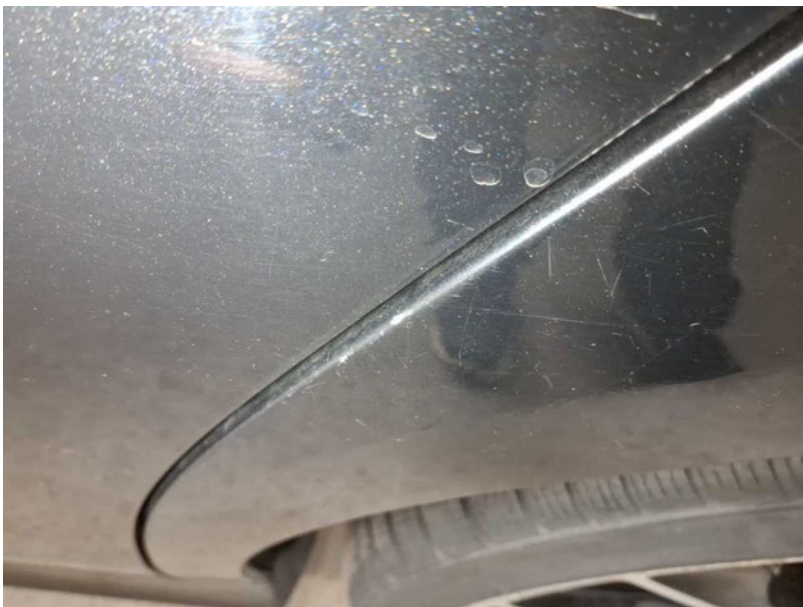
Beschädigung #9: Seitenwand links: Seitenwand - Kratzer - lackieren
