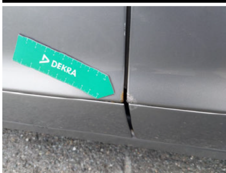
Tür / Vorne Links / Delle
