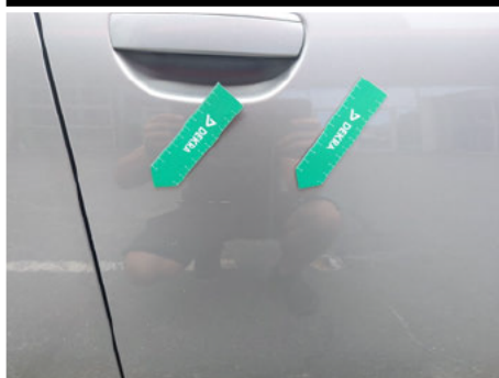
Tür / Vorne Rechts / Kratzer
