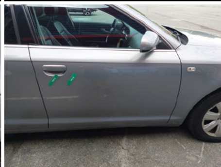
Tür / Vorne Rechts / Kratzer
