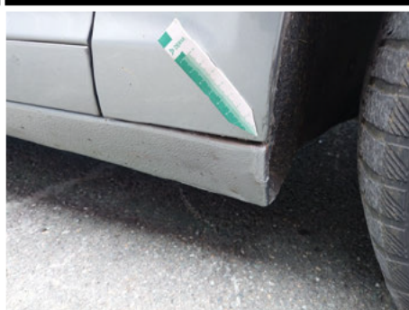
Schweller / Rechts / Rost
