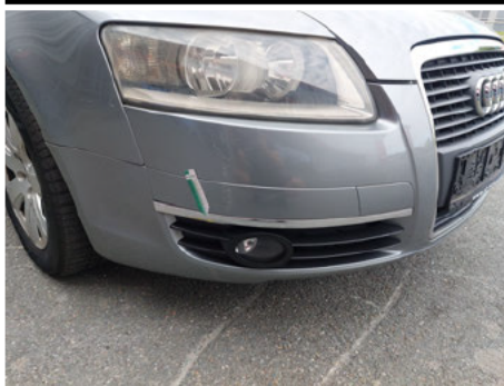
Stoßfängerleiste / Vorne Rechts / Abgewetzt
