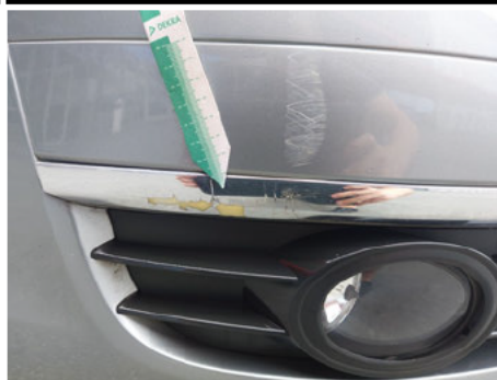
Stoßfängerleiste / Vorne Rechts / Abgewetzt
