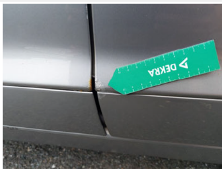
Tür / Hinten Links / Delle
