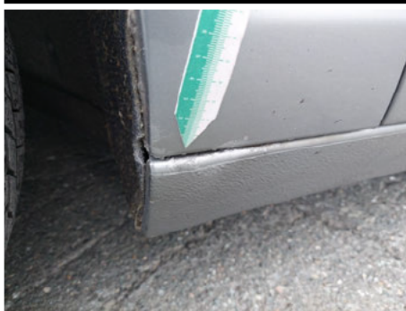
Schweller / Links / Rost
