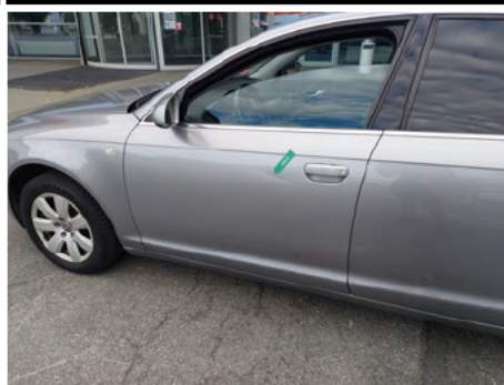
Tür / Vorne Links / Delle
