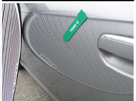
Tür / Vorne Links / Delle
