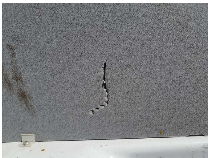
Damage 10: Boot lid / rear door: Rear door - right side (+ Innenverkleidung erneuern) - Deformed - Paint
