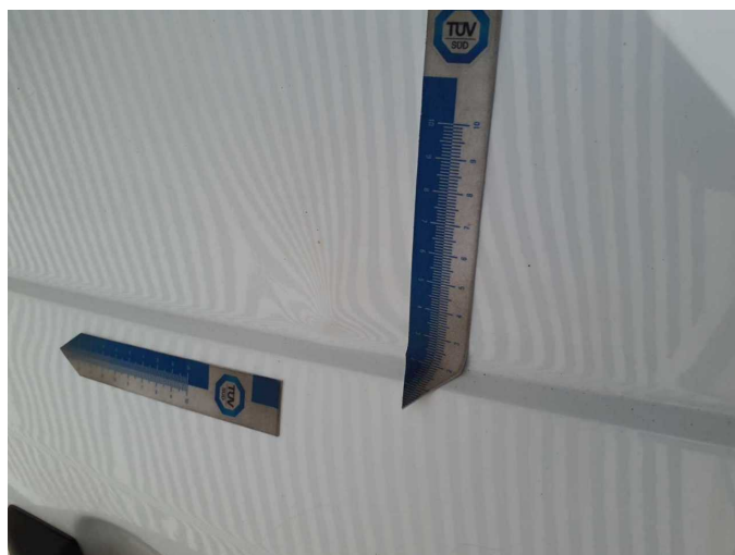
Damage 10: Boot lid / rear door: Rear door - right side (+ Innenverkleidung erneuern) - Deformed - Paint
