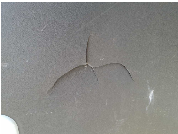
Damage 5: Boot lid / rear door: Rear door - left side (Innenverkleidung) - Broken / torn - Replace
