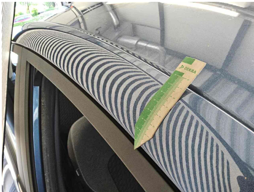
Bild 21 : Dachholm rechts, Delle
