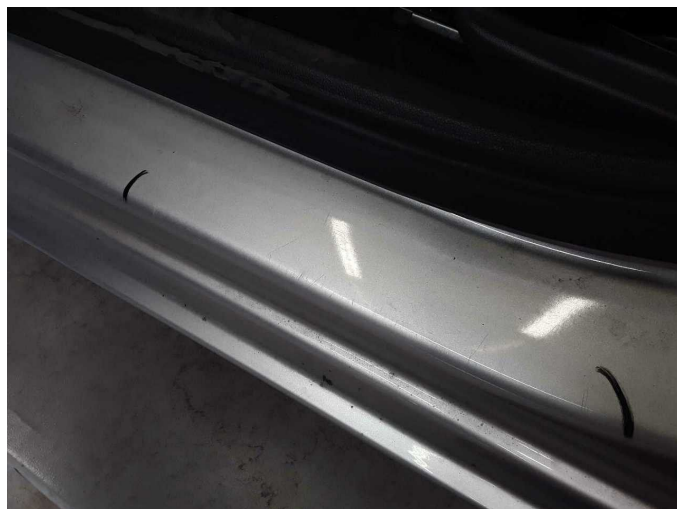
Damage 8: Sill - left side: Sill (Einstieg Tür vorn links) - Scratch(es) - Paint
